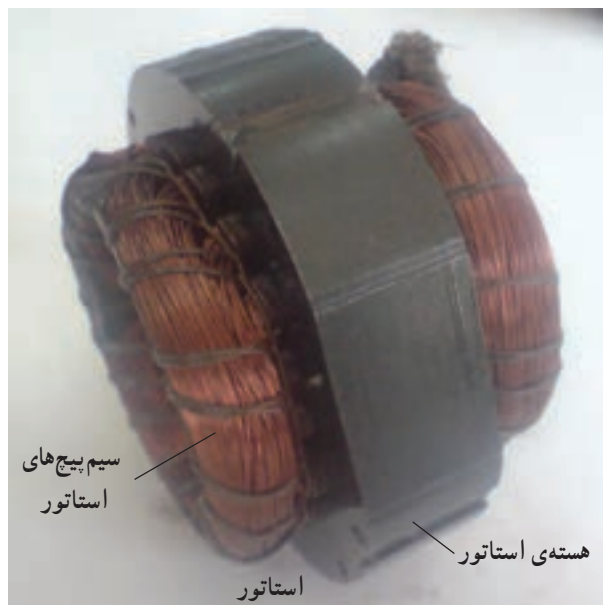
شکل ۱-۲ استاتور و روتور یک کمپرسور بسته ی تناوبی
