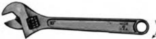
شکل ۴۴-۱- آچار فرانسه، توصیه می‌شود هنگام استفاده از این آچار همواره آن‌را در جهت فلش بکشید.
