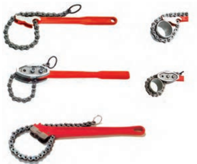
شکل ۴۶-۱- چند نوع آچار زنجیری
