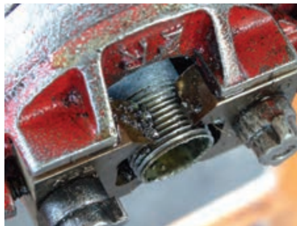
شکل ۳۵-۱- پایان حدیده‌کاری با عبور دو دندان از سر لوله
