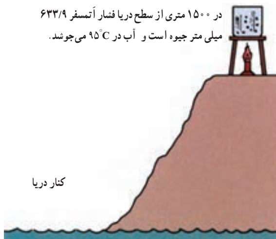
شکل ۱۰-۲- آب در فشار 633/9 میلی متر جیوه در دمای 95^{\circ}\text{C} می جوشد.
