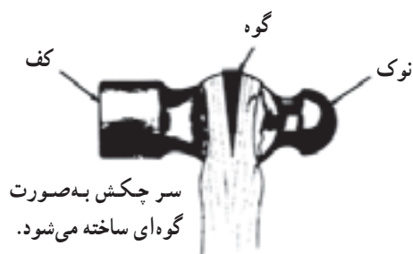
شکل ۱-۲۵- الف - دسته‌ی چکش باید با گوه محکم شود تا بیرون نبرد
