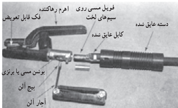
شکل ۲۲-۱- انبر الکتروود
