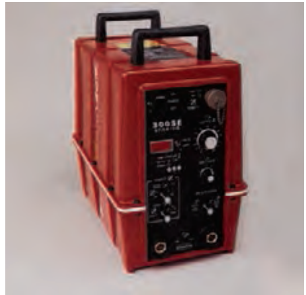
شکل ۱۵-۱-الف- ماشین جوش‌کاری اینورتر با توان زیاد و سبک (۲۶cm × ۴۳cm × ۴۹cm)
