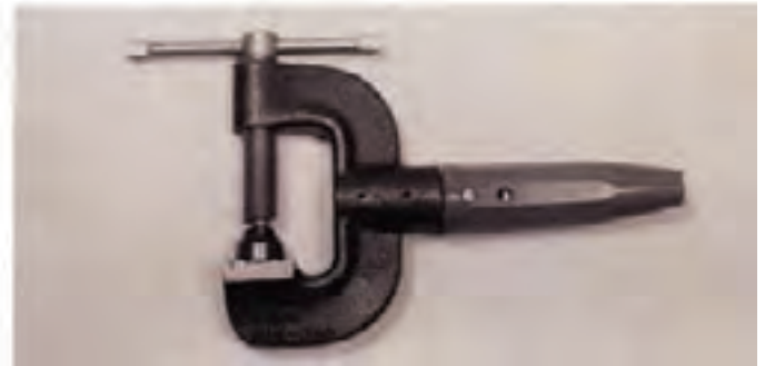
پ- گیره اتصال زمین از نوع AC برای کابل قطعه کار
