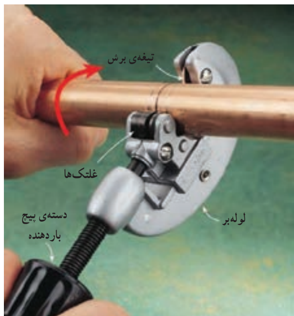
شکل ۱۱-۱- طریقه‌ی بریدن لوله‌ی مسی با لوله‌بر
