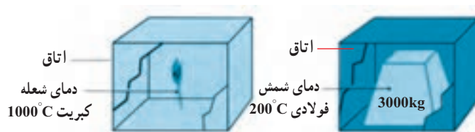
شکل ۱-۱- شعله کبریت دمای بیشتری را از شمش فولادی دارد با وجود این شمش فولادی گرمای بیشتری را در وجود خود نگه داشته و هوای اتاق را بیشتر گرم خواهد کرد.
