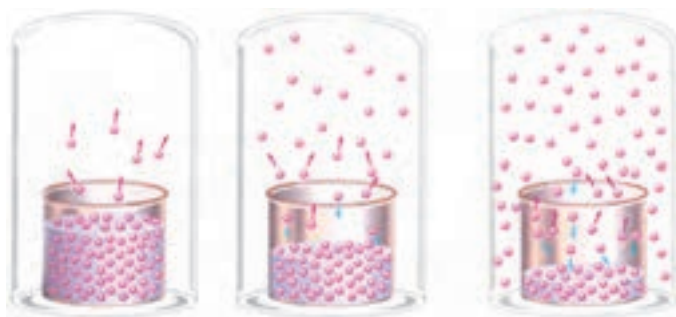
شکل ۱-۷- بخار شدن یک مایع در ظرف سر بسته
