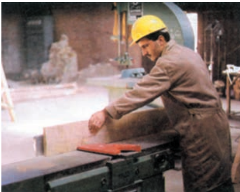
شکل ۱-۷۵- رنده کردن ضخامت (تر) تخته با رنده‌ی برقی
