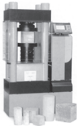
نمونه‌هایی از دستگاه‌های آزمایش مقاومت فشاری بتن که صفحه‌ی نمایش آن‌ها یا به صورت عقربه‌ای و یا دیجیتالی است.
