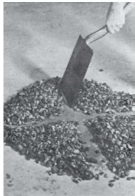
شکل ۲-۳- روش تریب برای نمونه برداری مطلوب شکل ۲-۴- استفاده از قوطی مقسم برای تقسیم نمونه به طور مکانیکی
