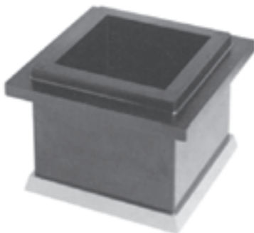
قالب نمونه های مکعبی بر اساس استاندارد BS
