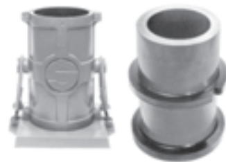
قالب نمونه‌های استوانه‌ای براساس استاندارد ASTM
