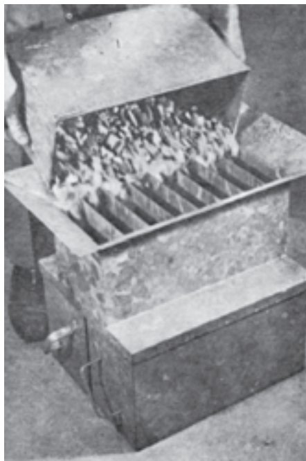
شکل ۲-۳- روش تریب برای نمونه برداری مطلوب شکل ۲-۴- استفاده از قوطی مقسم برای تقسیم نمونه به طور مکانیکی
