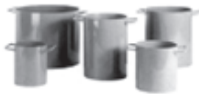
ظروف مختلف برای تعیین وزن مخصوص مصالح سنگی
