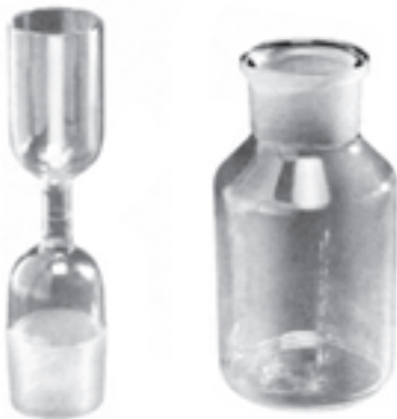
بطری پیکنومتر برای تعیین چگالی ظاهری مصالح که براساس استاندارد DIN 12039 ساخته شده است.
