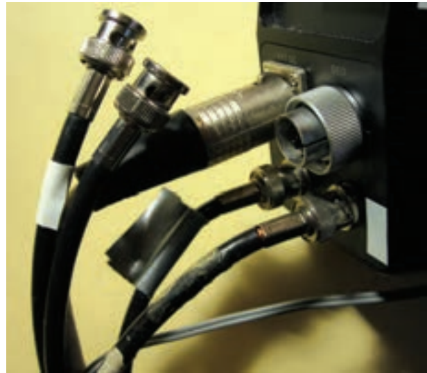
شکل ۴-۱۵- اتصال چند BNC به دستگاه
