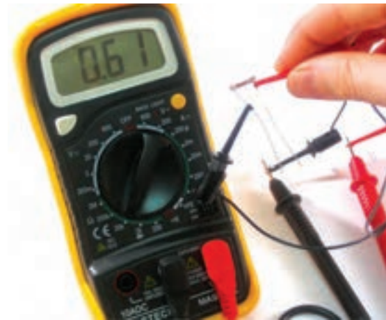
شکل ۳-۲۲- اندازه گیری مقاومت LDR
