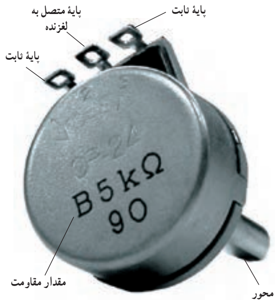
شکل ۳-۳ مقدار نوشته شده روی مقاومت
