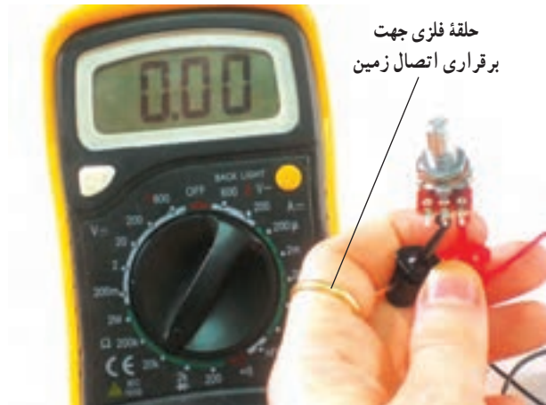
شکل ۳-۸- اتصال مقاومت متغیر به مولتی‌متر دیجیتالی
