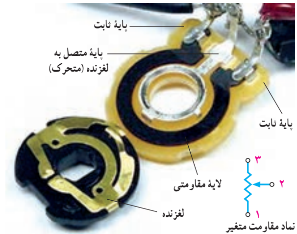
شکل ۲-۳- ساختمان داخلی مقاومت
