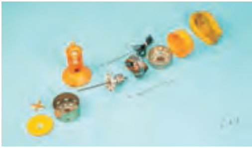
شکل ۱۸-۸ - نمایش ظاهری و اجزای یک واترپمپ
