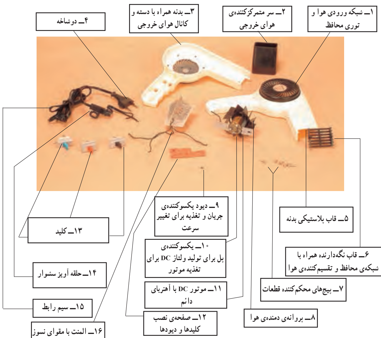
شکل ۴۲-۶- اجزای ساختمانی یک نمونه سشوار
