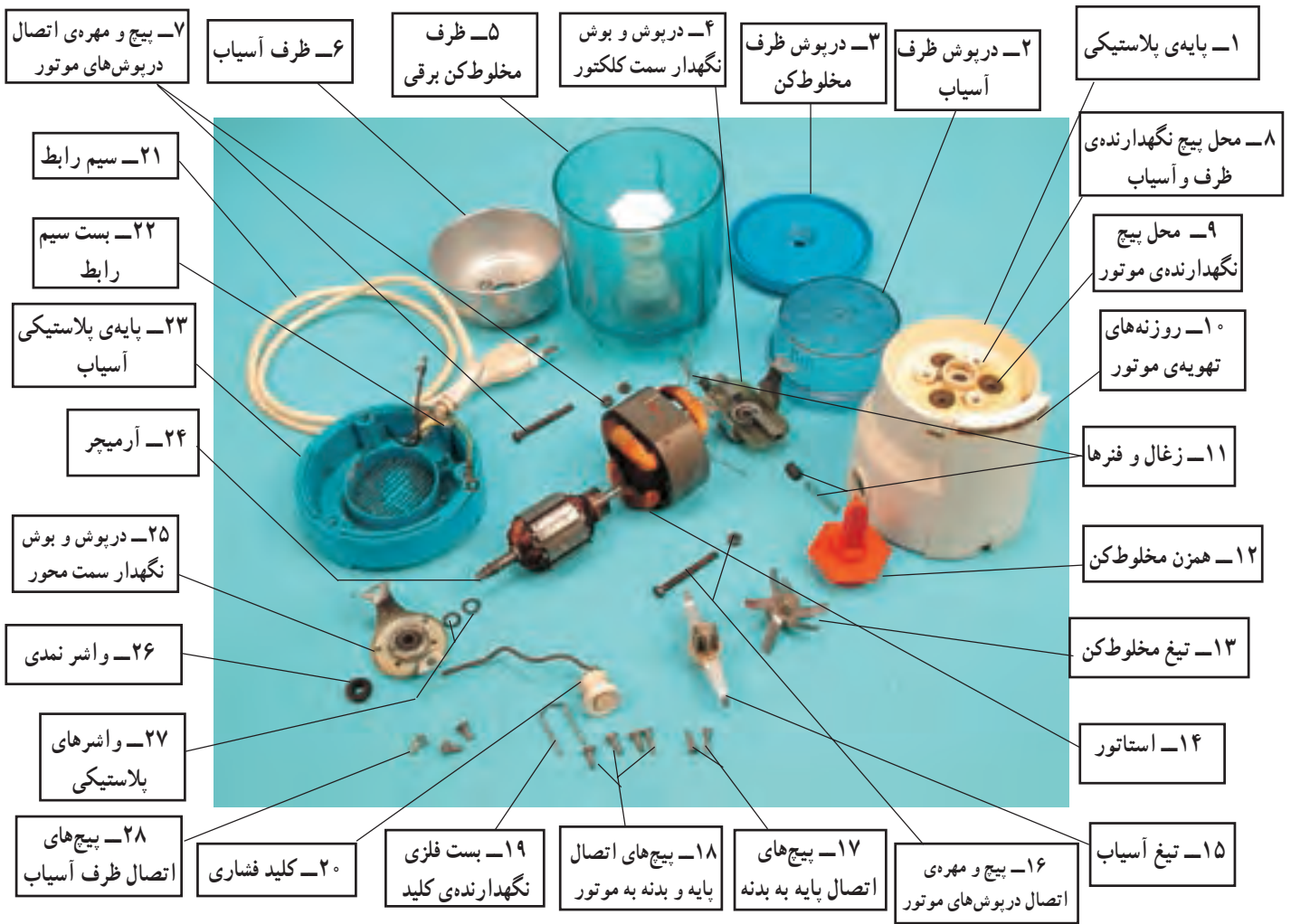
شکل ۴-۳۲- اجزای ساختمانی یک نمونه مخلوط‌کن برقی
