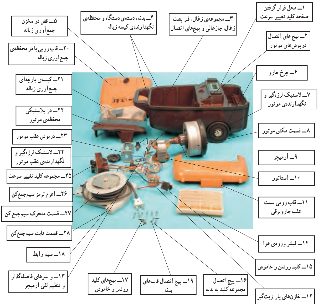
شکل ۲-۵۲ - اجزای ساختمانی یک نمونه جارو برقی
