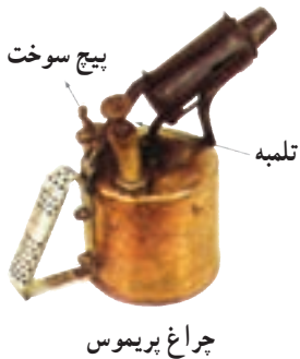
شکل ۳-۴ هویه‌ی ساده و دستگاه گرم‌کننده‌ی آن
