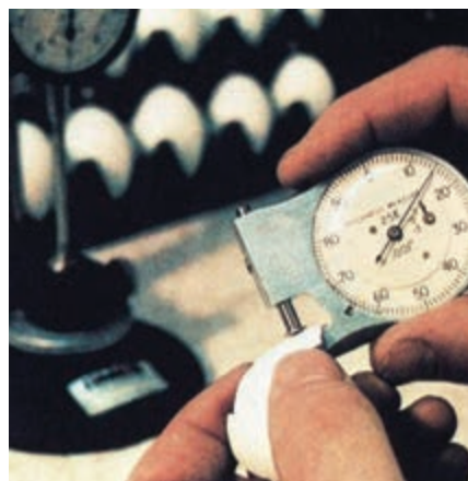
تصویر ۱-۲۵ - اندازه‌گیری ضخامت پوسته با میکرومتر
