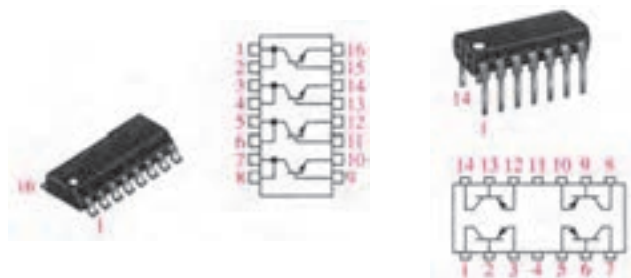
(ت) چهار ترانزیستور در یک بسته بندی به صورت DIPIC 1 (ج) چهار ترانزیستور در بسته بندی نصب سطحی
