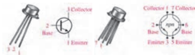
(ب) ترانزیستور در بسته دوتایی (ت) ترانزیستور با بسته‌بندی TO 18
