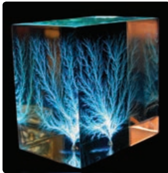
شکل ۱-۳۰ فروریزش الکتریکی باعث تشکیل مسیرهای رسانایی سرخس شکلی در دی الکتریک شده است.
