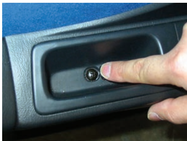
شکل ۲-۱۸۲ پیچ اتصال قاب سوئیچ به بدنه
