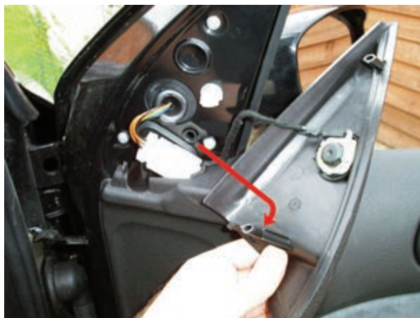
شکل ۱۶۵-۲ خارهای روی قاب و محل نصب آن
