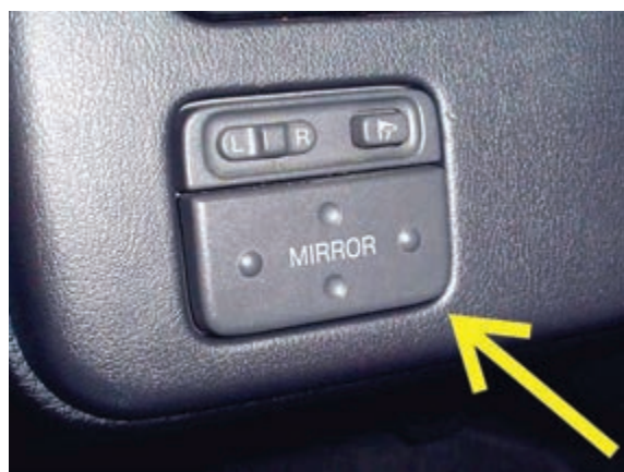
الف – سوئیچ آینه‌های جانبی یک نوع خودرو
