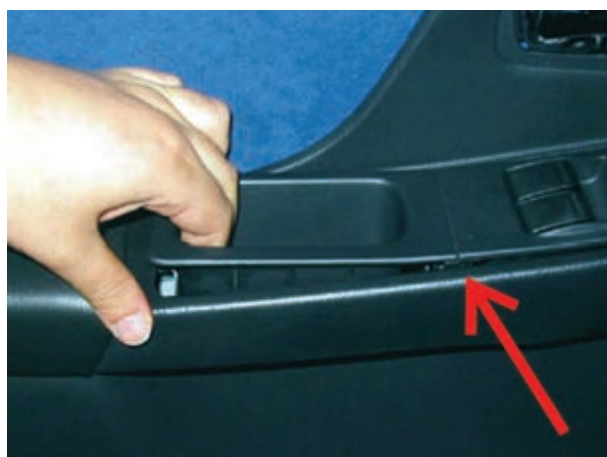
شکل ۲-۱۸۳ خارج نمودن قاب سوئیچ‌ها
