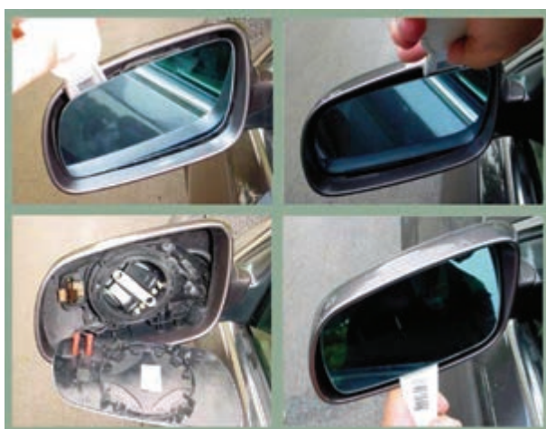
شکل ۱۶۷-۲- بیرون آوردن آینه از داخل قاب آن
