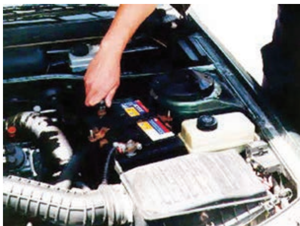
شکل ۱۶۴-۲ بازکردن کابل اتصال بدنه‌ی باتری
