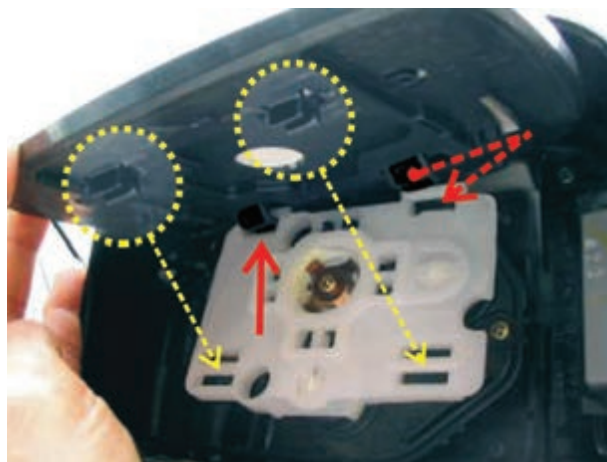
شکل ۱۶۲-۲ زائنده‌ها و خارهای اتصال آیینی به صفحه‌ی زیرین
