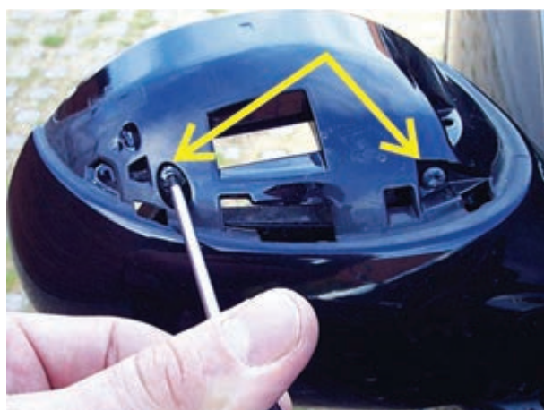
شکل ۱۷۴-۲- باز کردن پیچ‌های قاب بیرونی آینه
