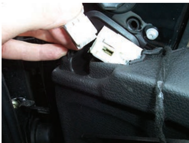
شکل ۱۶۶-۲- جدا کردن سوکت سیم کشی آینه
