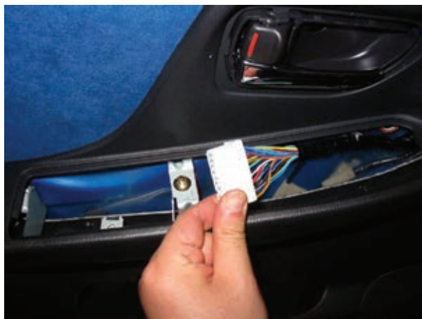
شکل ۱۸۵-۲ سوکت اتصال دسته سیم به سوئیچ‌ها
