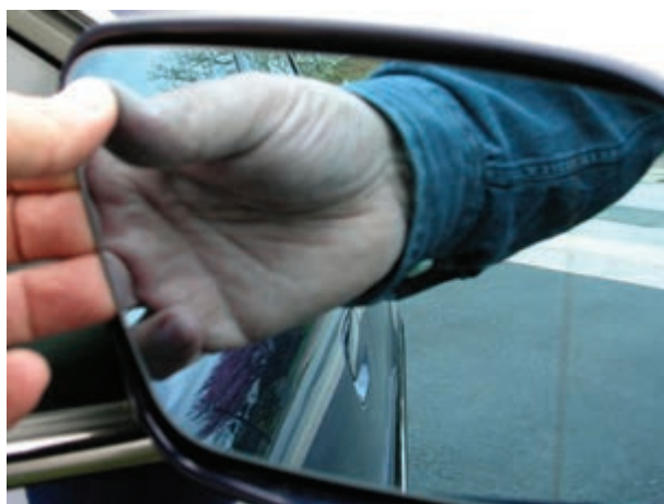
شکل ۱۶۹-۲- خارج کردن شیشه‌ی آئینه از داخل قاب بیرونی
