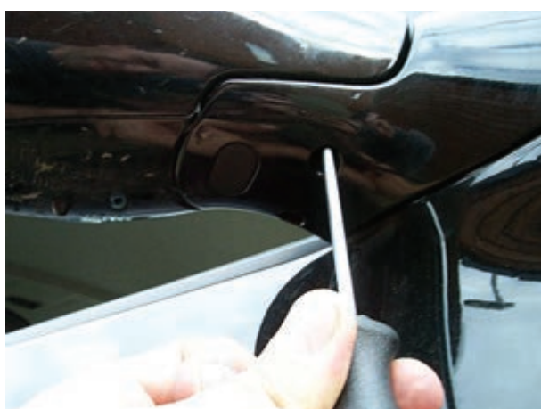
شکل ۲-۱۷۶ بازکردن پیچ روی پایه ی بیرونی آینه
