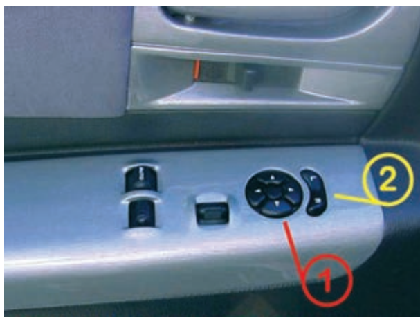
ب - مجموعه سوئیچ آینه‌های جانبی و شیشه بالابر شکل ۱۸۰-۲ - سوئیچ آینه‌های جانبی
