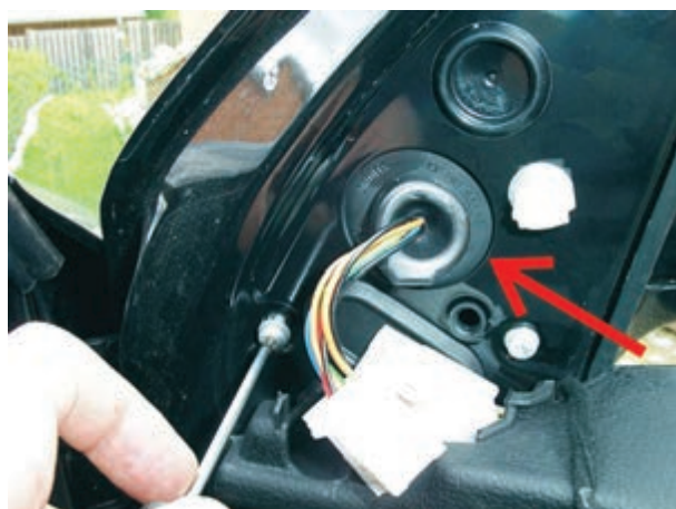
شکل ۲-۱۷۸- بازکردن پیچ نگه دارنده‌ی پایه‌ی اصلی آینه
