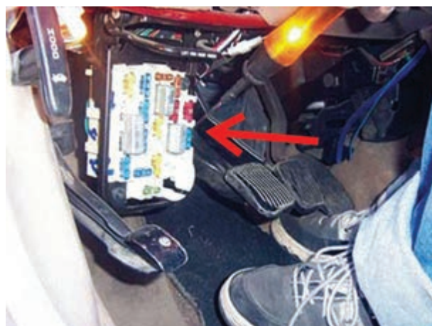
شکل ۱۸۹-۲- آزمایش پایه‌های فیوز
