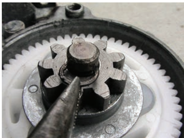
شکل ۱۲۹-۲ جانداختن خار فنری
