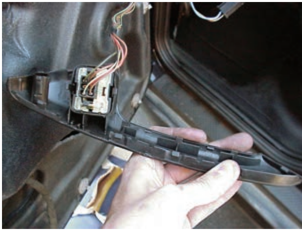
شکل ۱۱۸-۲- اتصال سوکت سوئیچ شیشه بالابر
