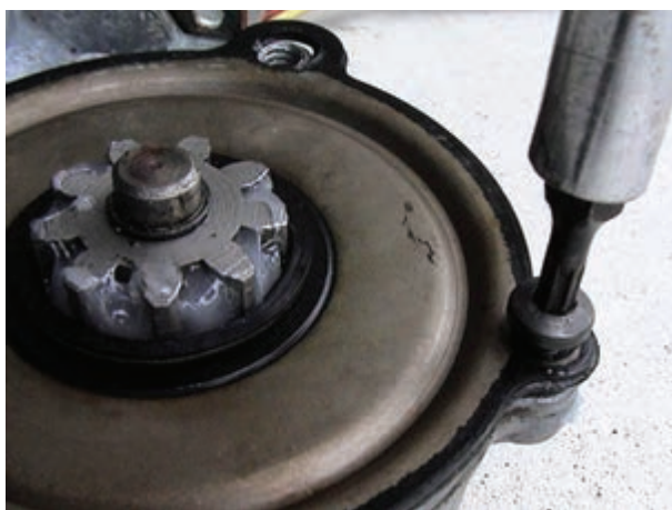
شکل ۱۳۱-۲- بستن پیچ‌های درپوش به بدنه
