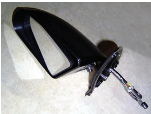
شکل ۱۵۶-۲- آینه‌ی جانبی و مکانیزم حرکت آن
