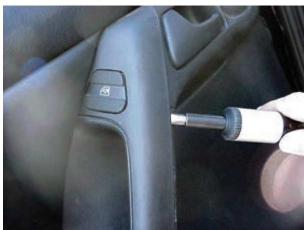
شکل ۲-۱۱۰- جدا کردن قاب سوئیچ شیشه بالابر
