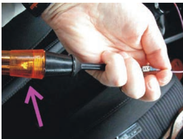
شکل ۱۵۲-۲- استفاده از چراغ آزمایش برای تشخیص سیم حامل جریان الکتریکی
