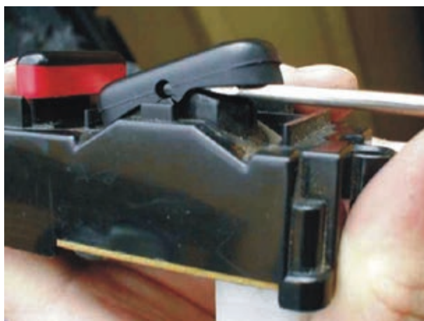
شکل ۲-۱۴۵- تعویض شستی معیوب
