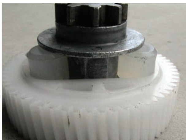
شکل ۱۲۸-۲ سوار کردن چرخ دنده‌ی فلزی
