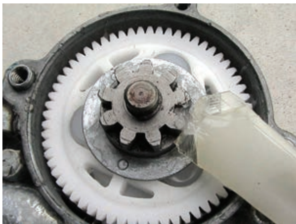
شکل ۱۳۰-۲- روغن کاری چرخ دنده‌ها
