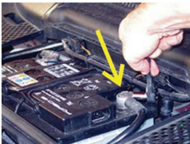
شکل ۱۴۱-۲- باز کردن کابل اتصال بدنه‌ی باتری
