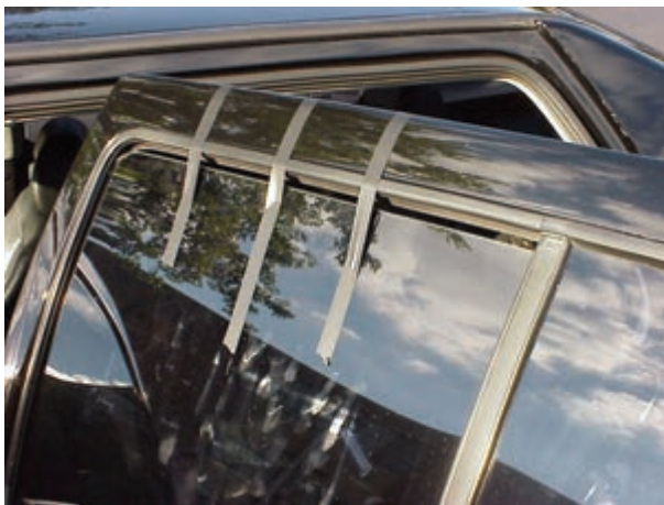
شکل ۱۱۹-۲- مهار کردن شیشه ی در به وسیله ی نوار چسب
