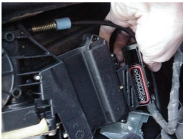
شکل ۱۲۲-۲- جدا کردن سوکت اتصال الکتریکی از شیشه بالابر
