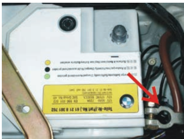
شکل ۲-۱۰۹- باز کردن اتصال منفی باتری
