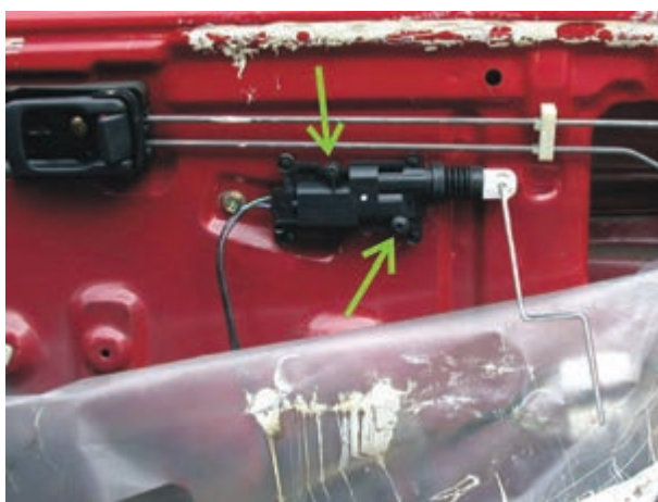
شکل ۲-۲۹ اتصال عملگر الکتریکی در روی در خودرو
