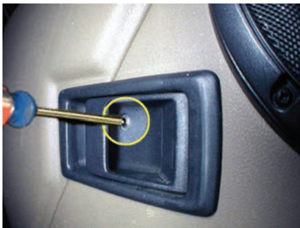
شکل ۳۶-۲- باز کردن قاب دستگیره‌ی قفل در
