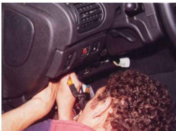
شکل ۲-۹۵- آزمایش برقراری جریان الکتریکی مدار
