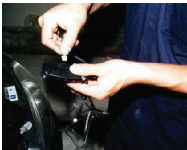
الف – اتصال سوکت سیم کشی به چشمی الکترونیک
