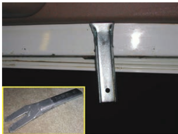
شکل ۲-۳۵- اهرم خاردرآر و نحوه‌ی استفاده از آن
