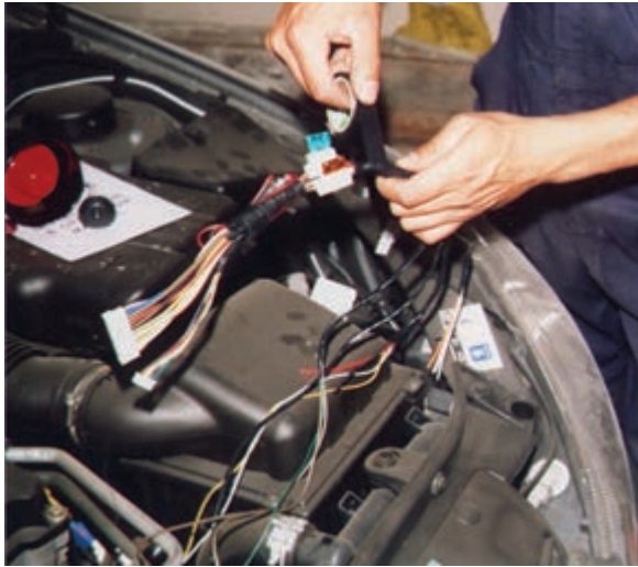
شکل ۲-۷۷- نحوه‌ی عایق‌بندی سیم‌های مدار الکتریکی دزدگیر
