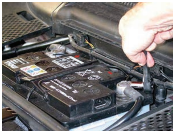
شکل ۲-۳۳- باز کردن اتصال بدنه‌ی باتری
