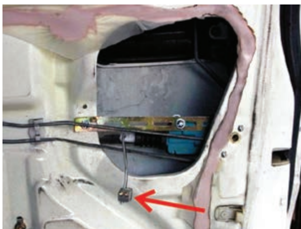
شکل ۳۸-۲- باز کردن بست فلزی از روی میله‌ی قفل کن دستی
