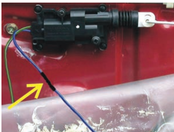
شکل ۲-۴۹- عایق کاری محل اتصال سیم‌ها به یکدیگر
