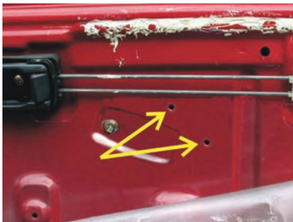
شکل ۲-۲۷ سوراخ کاری بدنه‌ی داخلی در خودرو
