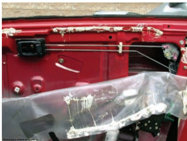
شکل ۲۶-۲- جدا کردن پلاستیک محافظ روی در
