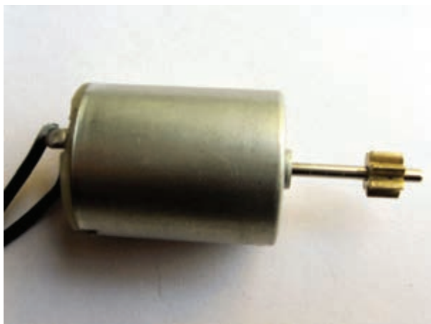
شکل ۲-۱۷- موتور الکتریکی عملگر
