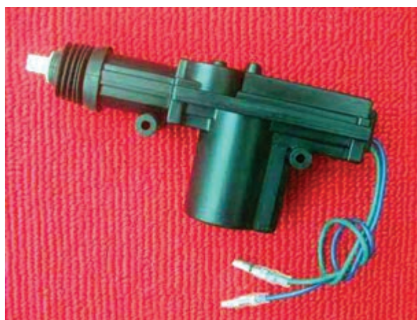
شکل ۲-۸- یک نوع عملگر سیستم قفل مرکزی
