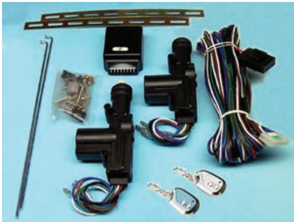
شکل ۱-۲- اجزای مدار قفل مرکزی
