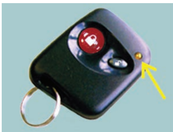
شکل ۲-۷- دیود نوری روی قاب ریموت کنترل
