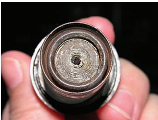
شکل ۱-۲۲۵- المنت حرارتی داخل سوئیچ فشاری
