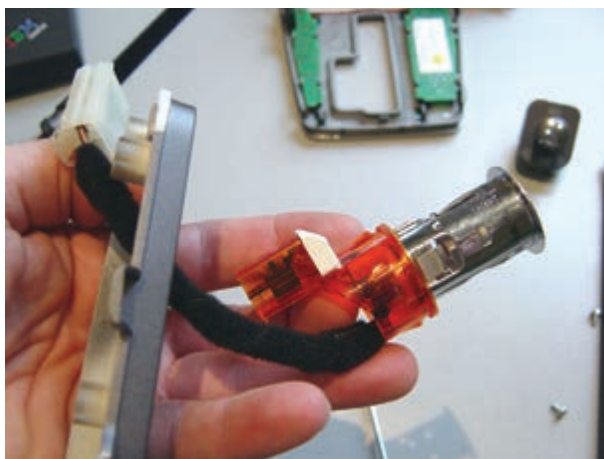
شکل ۱-۲۳۴- خارج کردن سیم و سوکت اتصال الکتریکی فندک از داخل قاب روی پانل
