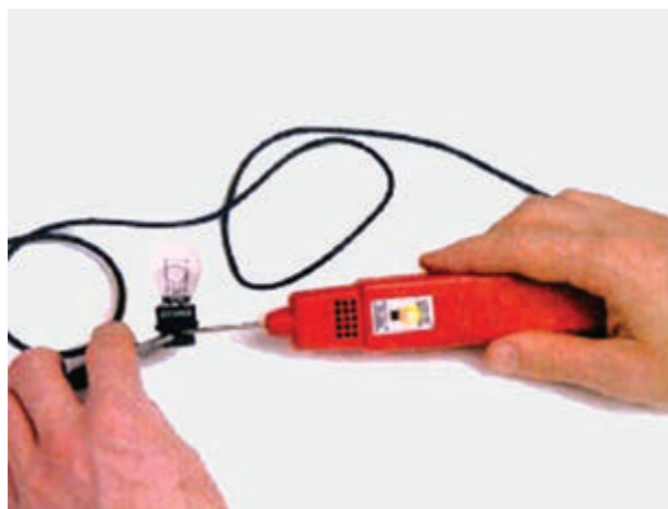
شکل ۲۱۹-۱- آزمایش لامپ چراغ صندوق عقب خودرو
