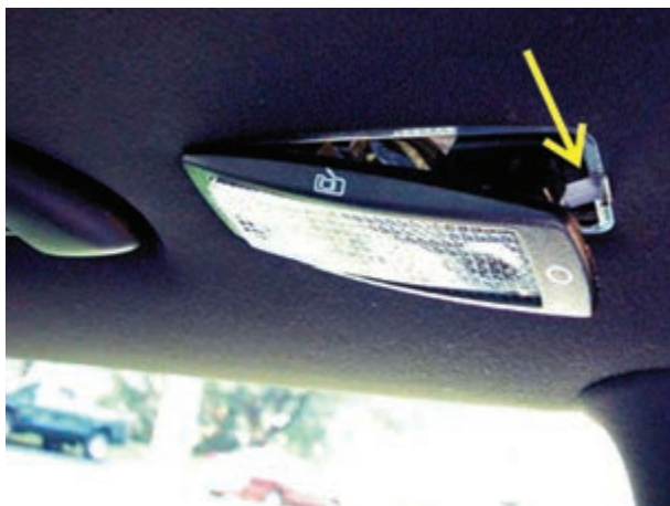
شکل ۱۹۱-۱- آزاد کردن خار و بیرون آوردن عدسی چراغ
