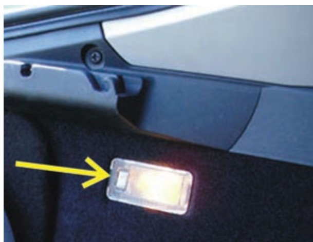
شکل ۲۱۸-۱- چراغ صندوق عقب و سوئیچ روی آن
