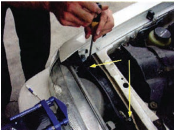
شکل ۱۶۷-۱- پیچ‌های تنظیم چراغ بزرگ جلو
