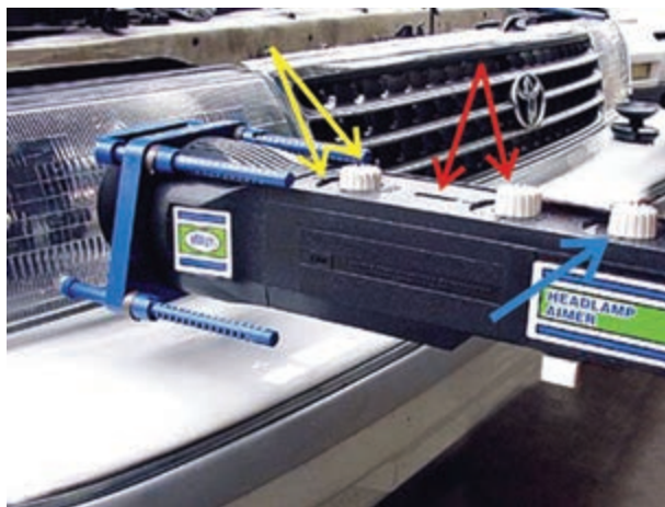
شکل ۱۶۱-۱- پیچ‌های تنظیم دستگاه تنظیم نور چراغ‌ها
