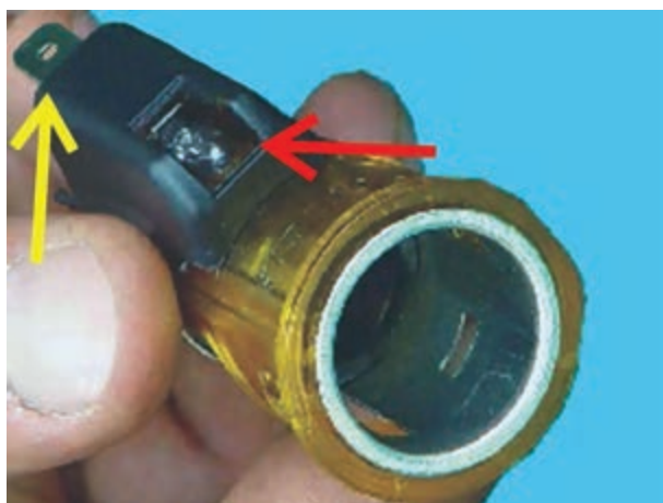
شکل ۱-۲۲۴- لامپ فندک و ترمینال الکتریکی آن
