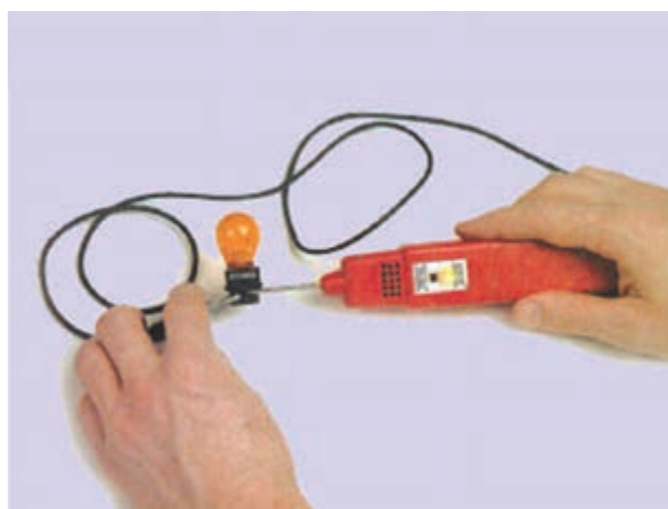
شکل ۱۸۲-۱- آزمایش لامپ چراغ راهنما
