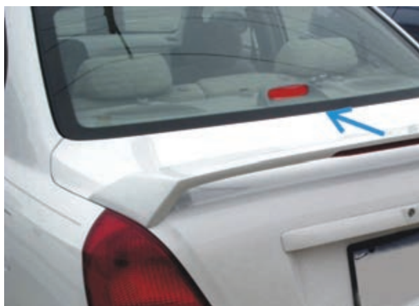
شکل ۱۶-۱- چراغ ترمز نصب شده در پشت شیشه‌ی عقب در یک نوع خودرو
