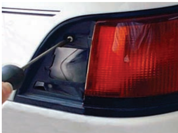
شکل ۱-۵۶- باز کردن پیچ‌های قاب چراغ
