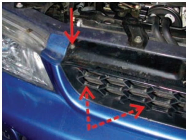
شکل ۳۶-۱- محل قرار گرفتن پیچ‌های اتصال جلوی پنجره به شبکه‌ی فلزی جلوی خودرو
