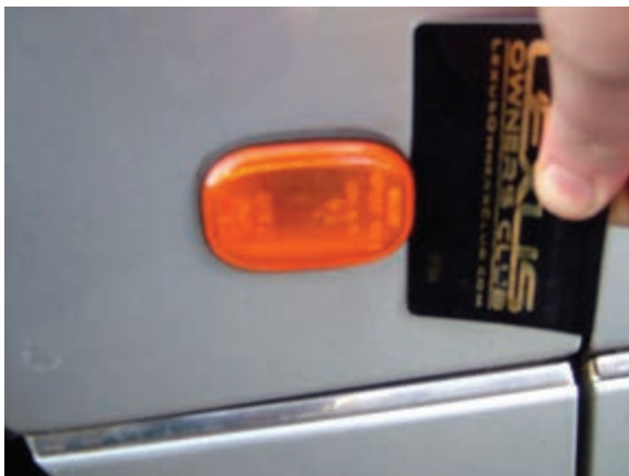
شکل ۱-۶۶- نحوه‌ی بیرون آوردن چراغ راهنما بغل یک نوع خودرو
