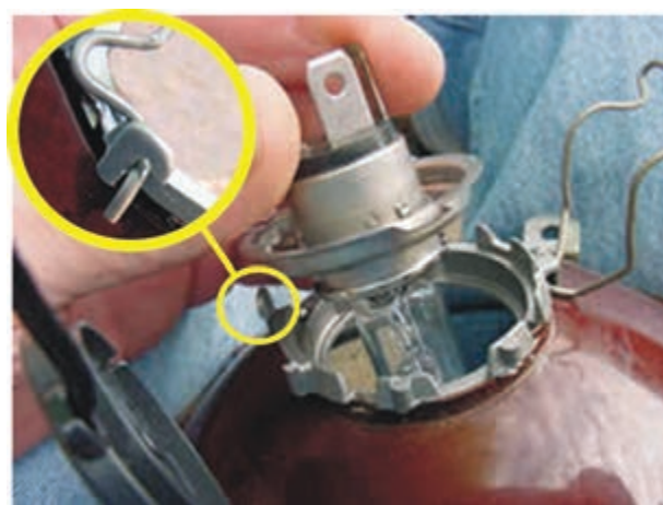
شکل ۱-۴۳- نحوه‌ی ثابت شدن لامپ درون کاسه‌ی چراغ
