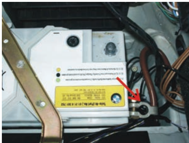
شکل ۳۵-۱- جدا کردن بست اتصال کابل بدنه‌ی باتری
