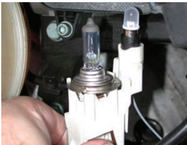
شکل ۱-۴۹ - پایه‌ی مشترک لامپ‌های چراغ روشنایی و پارک
