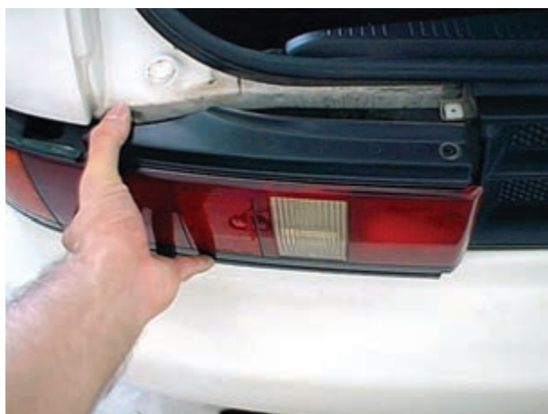
شکل ۱-۵۸- جدا کردن چراغ عقب از بدنه‌ی خودرو
