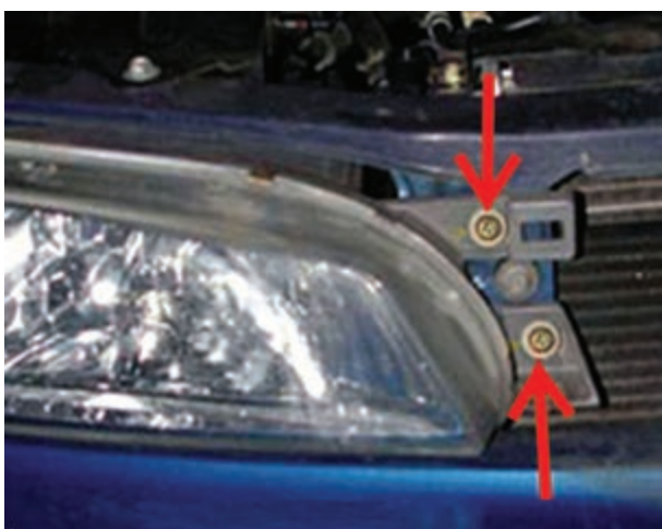
شکل ۱-۴۰- پیچ‌های نگه‌دارنده‌ی چراغ‌های بزرگ جلو
