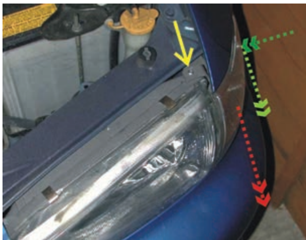
شکل ۱-۳۸- نحوه‌ی جداکردن چراغ جانبی روشنایی
