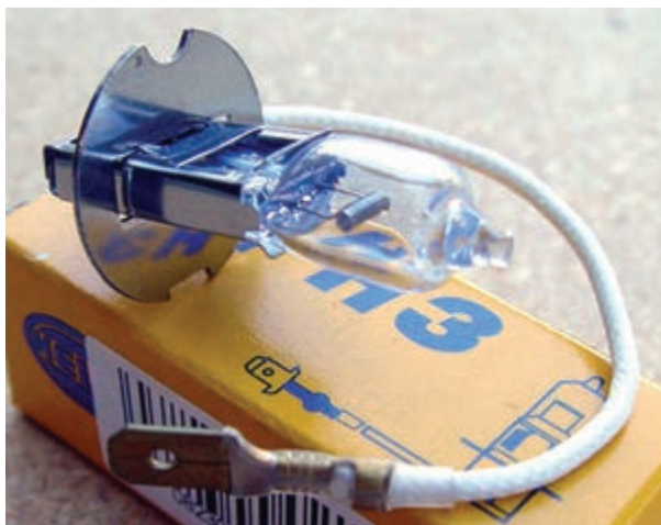
شکل ۱-۳۱- لامپ مورد استفاده در چراغ‌های مه‌شکن، نورافکن‌ها
