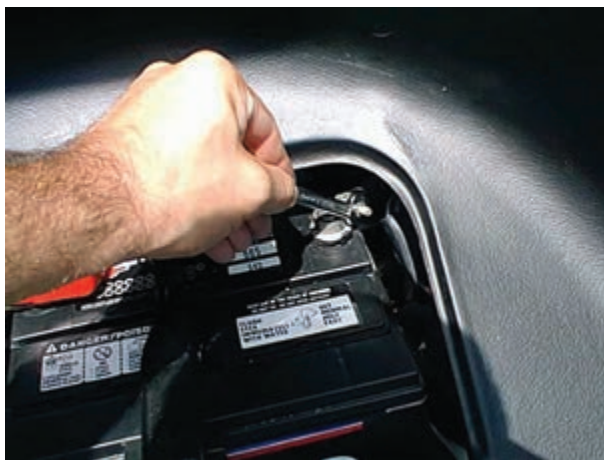
شکل ۱-۵۲ باز کردن بست ترمینال منفی باتری
