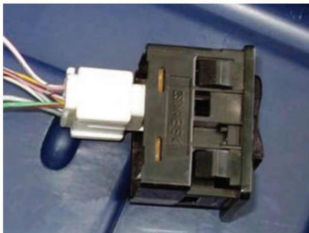
شکل ۱-۷۰- سوئیچ چراغ بزرگ جلو روی پانل
