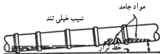
شکل ۱۱-۳ الف - نتیجه‌ی شیب زیاد لوله‌ی افقی فاضلاب
