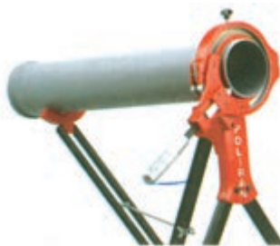
شکل ۲-۶۹ - لوله بر و بیخ‌زن پایه‌دار
