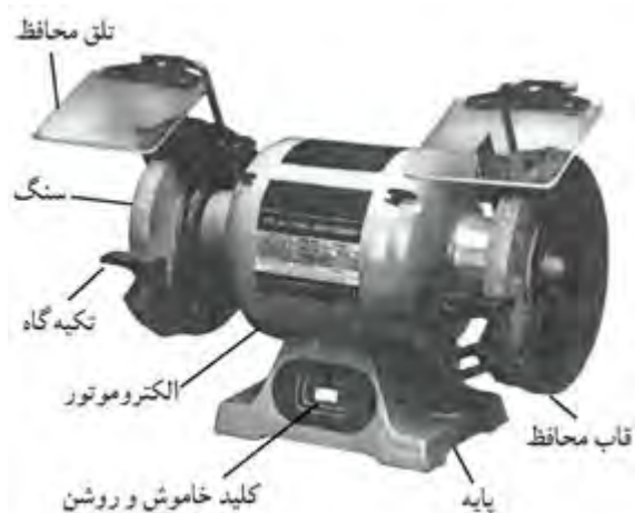
شکل ۱۲-۱۴. قسمت‌های مختلف سنگ سنباده.
