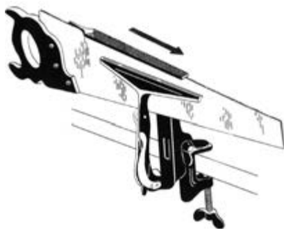
شکل ۱۴-۶۲- میزان کردن دندان‌های اره به وسیله سوهان.
