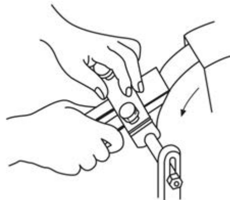
شکل ۱۴-۲۴- تیزکردن تیغه رنده با سنگ سنباده.
