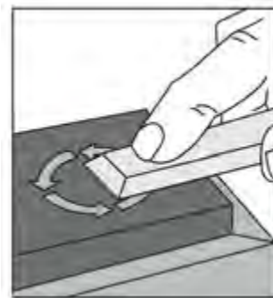
شکل ۱۴-۴۹- پلیسه‌گیری تیغه با سنگ نفت.
