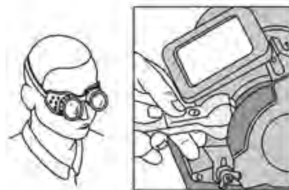
شکل ۱۴-۲۹- استفاده از عینک حفاظتی یا تلق محافظ، در هنگام کار.
