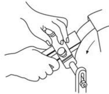
شکل ۱۴-۴۸- تیز کردن تیغه رنده، با استفاده از سنباده و ابزار کمکی.
