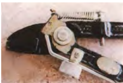
شکل ۱۴-۵۵- تنظیم انبر چپ و راست کن با پیچ‌های مفصوم.
