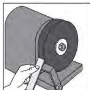
شکل ۱۴-۴۴- تنظیم تکیه‌گاه سنگ سنباده.
