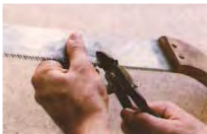
شکل ۱۴-۵۴- فم کردن بقیه دندانها به طرف پایین.
