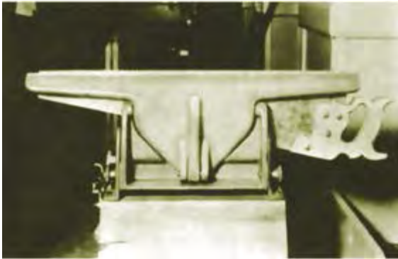
شکل ۱۴-۵۰- قرار دادن ارّه داخل تنگ.
