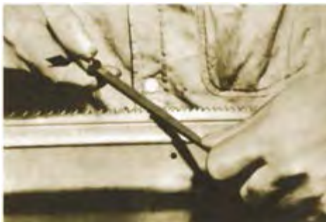
شکل ۱۴-۲۲- تیزکردن اره با استفاده از سوهان.
