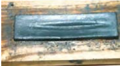
شکل ۴-۱۴- استفاده‌ی نادرست از سنگ نفت.
