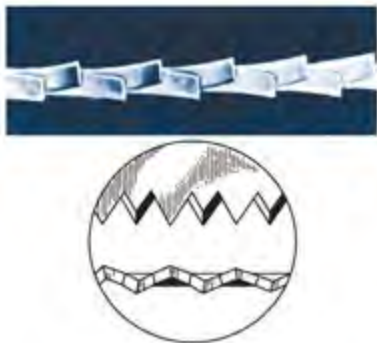
شکل ۱۷-۱۴. دندانه‌های چپ و راست شده.
