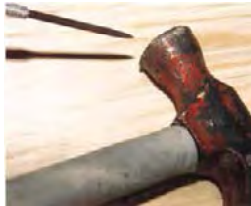
شکل ۷-۳۹- پلیسه‌ی ایجاد شده در سر چکش.
