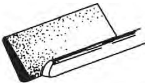
شکل ۱۱-۴۱- پلیسه‌گیری لبه‌ی مغار گلوبی.
