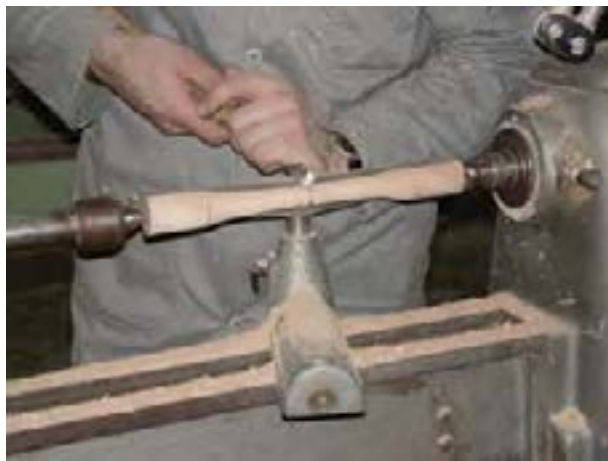
شکل ۱۱-۶۵- نمونه‌ی ایجاد شیار.
