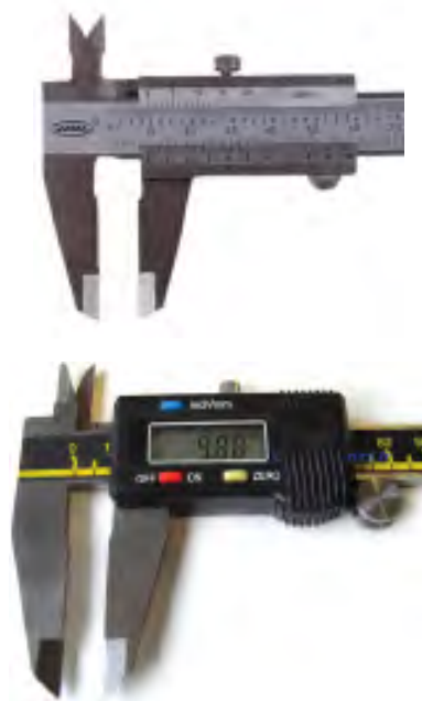
شکل ۱۱-۳۳- کولیس معمولی و دیجیتالی.
