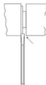
شکل ۱۱-۱۶- مغار نیزه‌ای یا قطع‌کن؛ برش عرضی.
