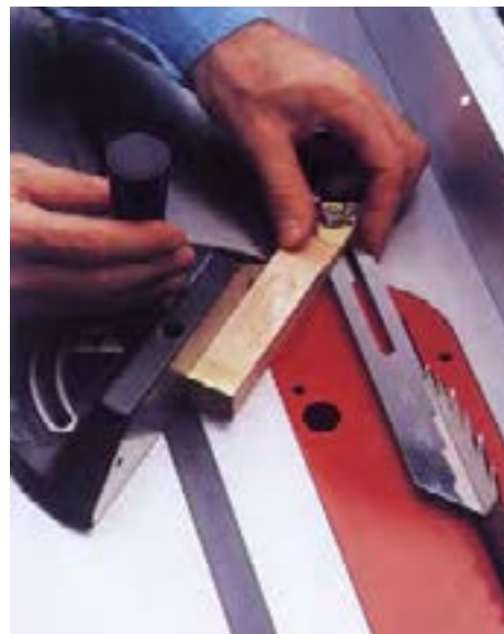
شکل ۱۲-۲۰- تنظیم زاویه‌ی تیغه
