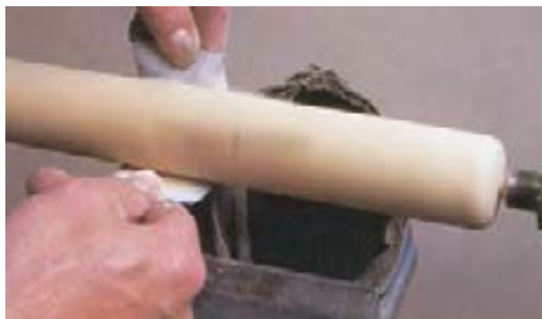
شکل ۱۱-۳۵- به وسیله‌ی سناده‌ی زبر، چوب فرامی‌گردد.
