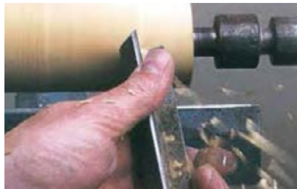
شکل ۱۱-۵۰- گرد کردن نهایی چوب با مغار گلوبی.
