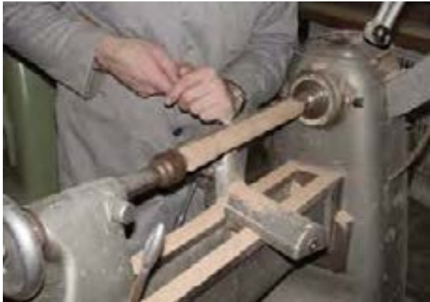
شکل ۱۱-۲۷- نمونه‌ی قرار گرفتن مغار گلوبی هنگام فراطی.
