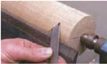
شکل ۱۱-۱۴- مغار مورب برای موه‌گیری و صاف کردن سطوح مورب.
