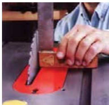
شکل ۱۲-۱۶- کنترل زاویه‌ی تیغه.
