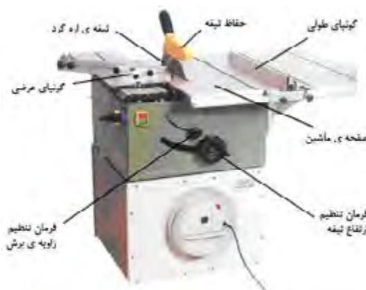
شکل ۱۲-۱ ماشین‌اره گرد میزی یا مجمعه‌ای.
