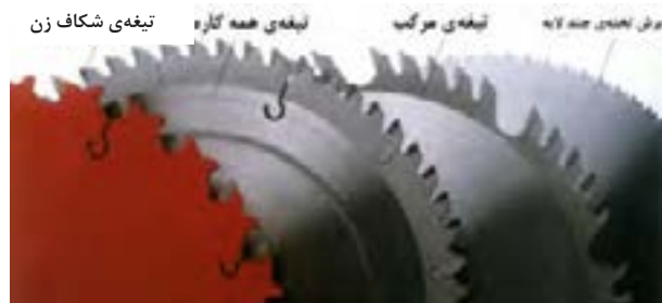
شکل ۱۲-۱۰ - چند نوع تیغه‌ی پر کاربرد.
