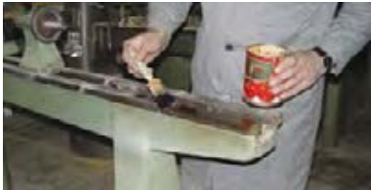
شکل ۱۱-۴۵- تمیزکاری قسمت‌های ضروری و بدون رنگ ماشین.
