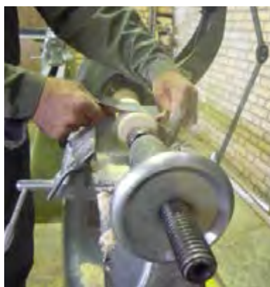
شکل ۱۱-۲۱- نمونه‌ی سنباده‌کاری قطعه چوب فراطی شده.
