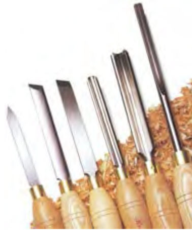
شکل ۱۱-۱۲- فرم‌های متفاوت نوک مغارها.
