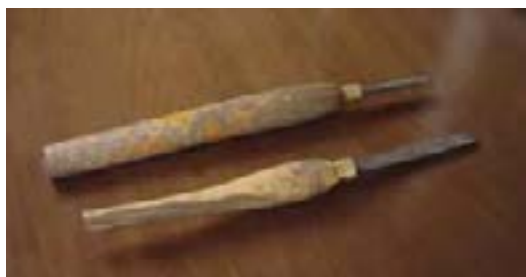
شکل ۱۱-۲۰- نمونه‌ای از مغارهای با دسته‌ی معیوب.
