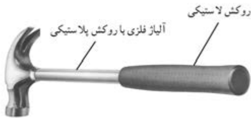
شکل ۷-۲۰- چکش فلزی همراه دسته فلزی.
