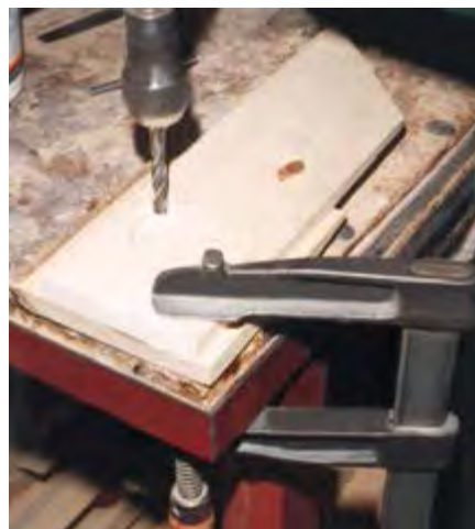
شکل ۵-۵۸- ایجاد سوراخ در قسمت داخلی قطعه کار.
