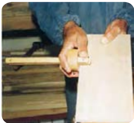
شکل ۶-۷۷. فماتکشی روی چوب با فماتکش تیره‌دار.
