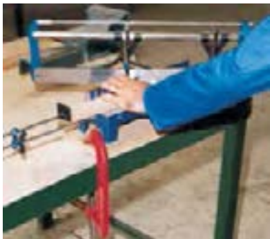
شکل ۵-۶۴- ایجاد برش ۴۵ درجه به وسیله‌ی اژه فارسی‌بُر.
