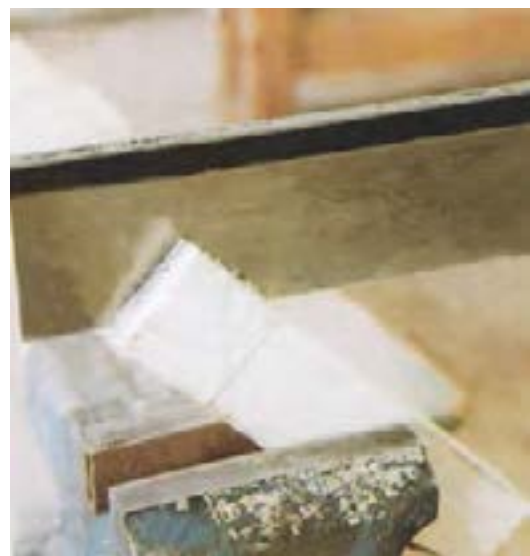
شکل ۵-۵۵. مالت افقی ارّه در پایان برش.
