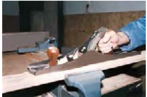
شکل ۶-۸۴- استقرار رنده بلند (دستگاه).
