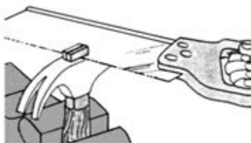
شکل ۷-۲۲- بریدن قسمت اضافی دسته‌ی چکش.
