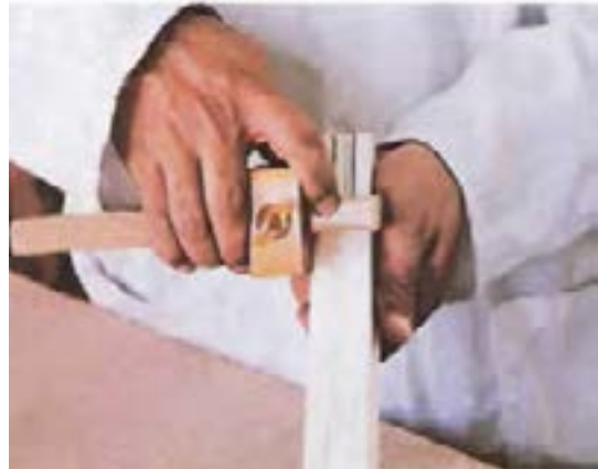
شکل ۵-۵۴. فلکشی با استفاده از فلکش تیزه‌دار.
