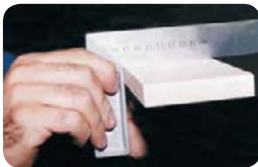
شکل ۶-۷۴. آزمایش صمت رنده‌کاری با گونیا
