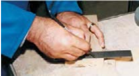
شکل ۶-۸۶- خط‌کشی با استفاده از گونیا.
