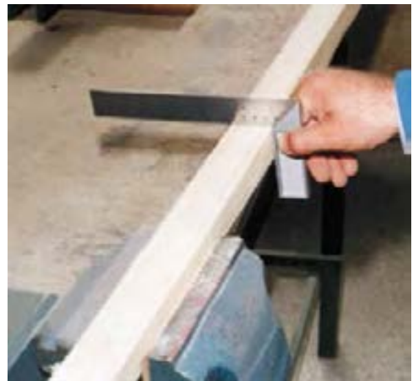
شکل ۶-۸۵- صمت گونیایی بودن قطعه کار با گونیا.
