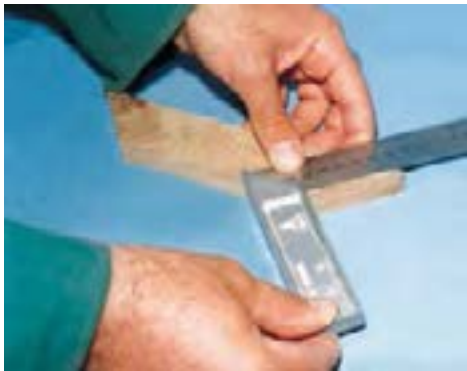
شکل ۵-۶۵- کنترل گونیا‌یی بودن قطعه کار.
