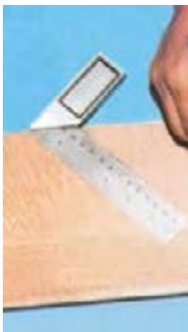
شکل ۶-۱۰۴- خط‌کشی فطوط ۴۵ درجه به وسیله‌ی گونیای معمولی.
