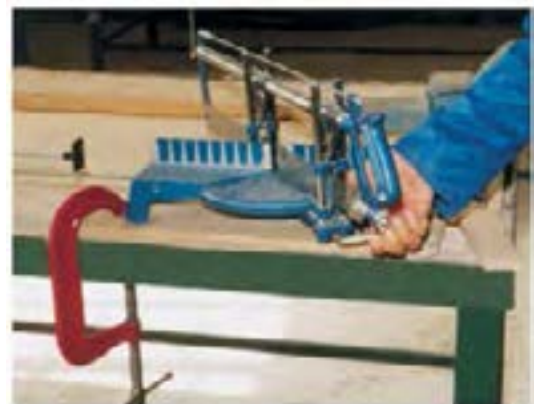
شکل ۵-۶۳- قرار دادن اژه روی زاویه‌ی موردنظر به کمک اهرم تنظیم.
