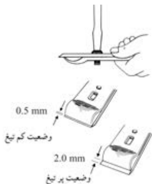
شکل ۶۵-۶- تنظیم و محکم کردن تیغه و پشت بند.
