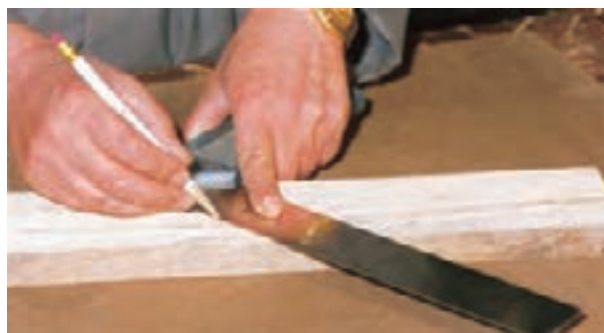
شکل ۶-۹۳- کار کردن با گونیای فارسی.
