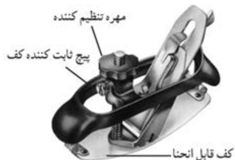
شکل ۶-۴۶- قسمت‌های مختلف رنده کاس و سینه.
