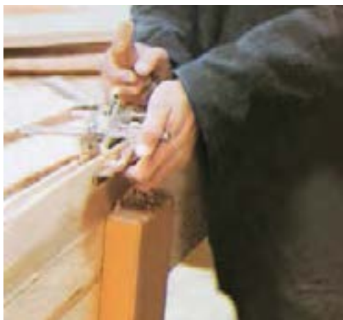
شکل ۸۲-۶. چگونگی کار با رنده کنشکاف.
