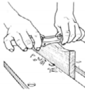
شکل ۶-۴۴- نمونه‌ی رندیدن قوس‌های دافلی.
