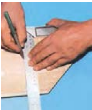
شکل ۶-۱۰۳- استفاده از گونیا برای خط‌کشی.
