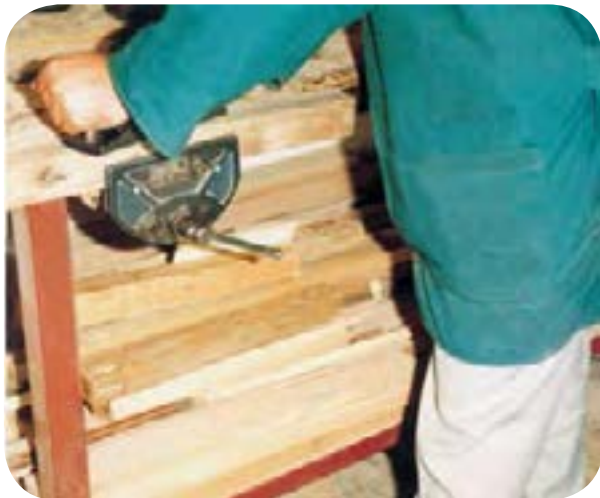
شکل ۶-۷۳- نمونه‌ی ایستادن هنگام رنده‌کاری.
