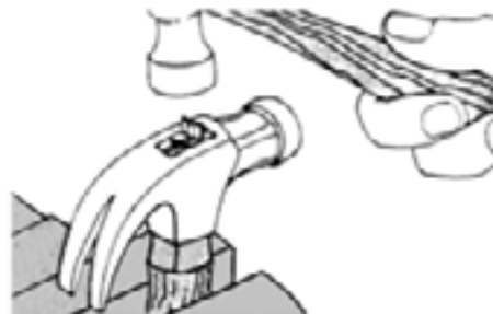
شکل ۷-۲۳- کوبیدن گوه به سر چکش.
