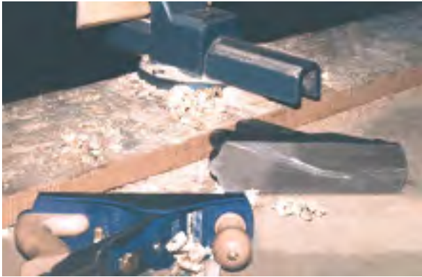
شکل ۶-۹۱- قرار دادن رنده در گودی میز کار.
