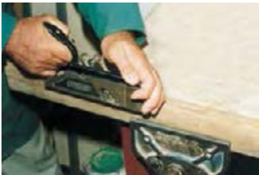
شکل ۶-۷۹. به کارگیری رنده بغل بدون گونیا.
