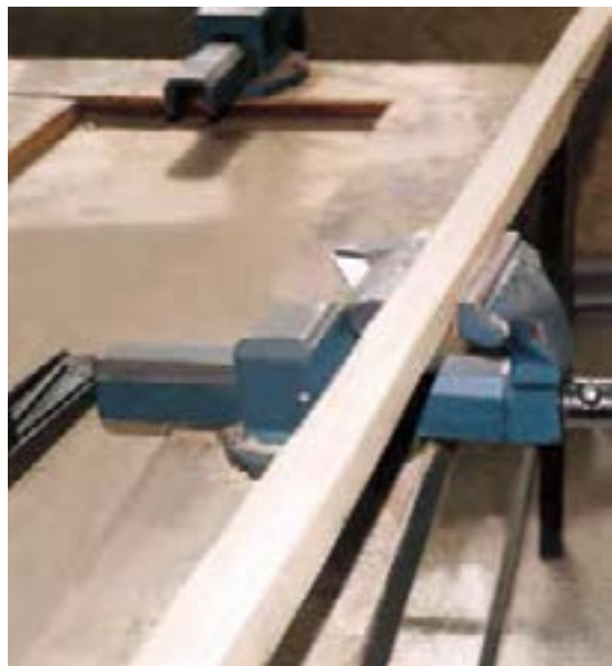
شکل ۸۳-۶. بستن قطعه کار به گیره میز کار.
