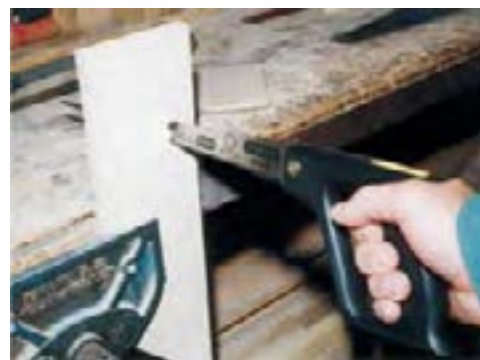
شکل ۵-۵۹- نمونه‌ی ایجاد سوراخ به وسیله‌ی اره نوکی.
