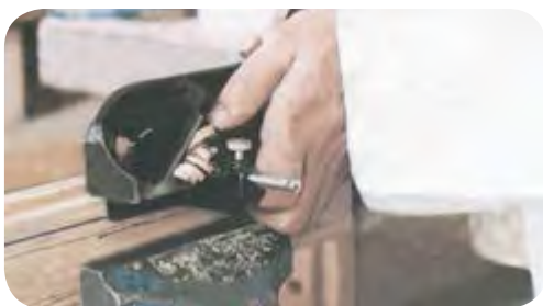
شکل ۶-۷۸. به کارگیری رنده بغل قابل تنظیم.
