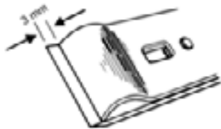
شکل ۶-۷- نمونه‌ی قرار گرفتن پشتی (روی تیغه).
