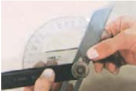
شکل ۱۰۰-۶- استفاده از نقاله در گونیای تاشو.
