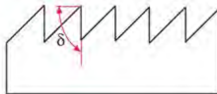
شکل ۵-۳۲- زاویه‌ی برش \delta مساوی ۹۰ درجه.
