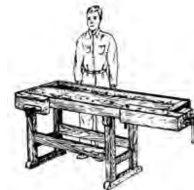
شکل ۲-۲- ارتفاع استاندارد میز کار.
