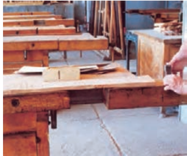
شکل ۱۶-۲. ثابت کردن قطعات روی میزکار، با استفاده از گیره و آهن نگهدارنده.
