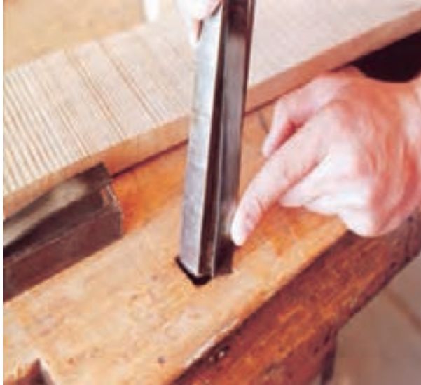
شکل ۲-۲۰- نمونه‌ی استقرار آهن نگهدارنده‌ی قطعه کار.
