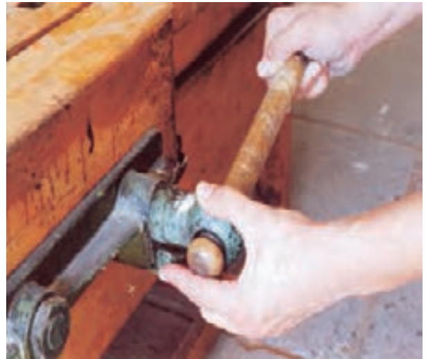
شکل ۲-۱۸- ضامن باز و بسته کردن آزاد گیره.
