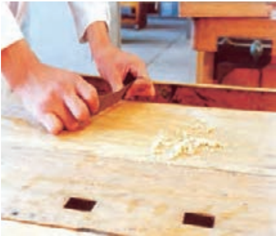
شکل ۱۷-۲. تمیز کردن سطح میز کار با لیسسه.
