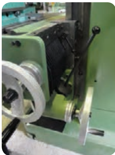
قفل بودن اهرم‌ها قبل از تنظیم میز گردان
