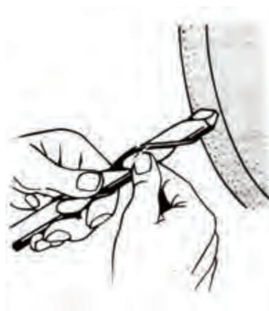
تیز کردن مته با دست و سنگ دو طرفه
