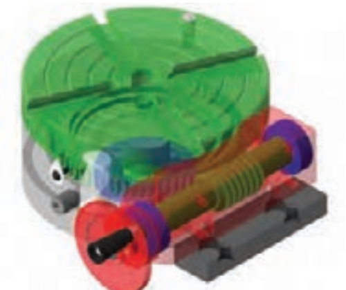
نمایش سیستم داخلی میزگردان
