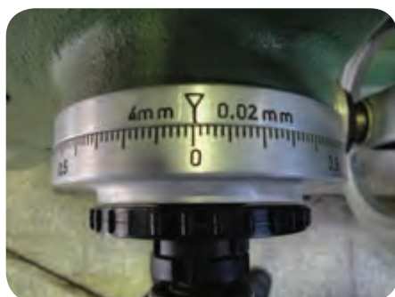
جابجایی دقیق میز ماشین فرز به کمک ورنیه‌ها
