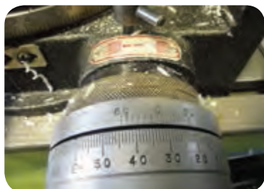
حلقه مدرج دستگیره میزگردان برای جابجایی دقیق‌تر
