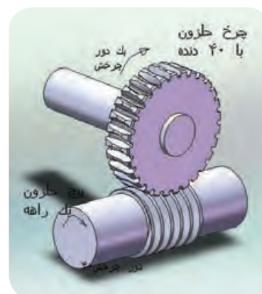
سیستم چرخ حلزون و پیچ حلزون
