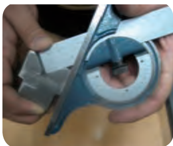
کنترل شیب قطعه با زاویه سنج انیورسال
