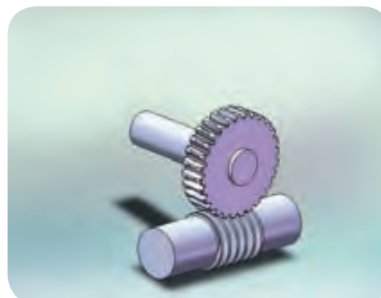
سیستم چرخ حلزون و پیچ حلزون
