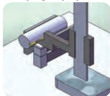
اندازه گیری عمق شیار
