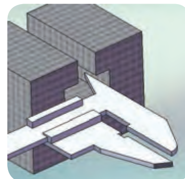
کنترل شیار T شکل
