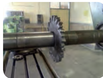
نصب تیغه فرز شیار تراش بر روی ماشین فرز افقی
