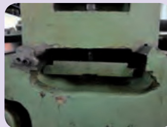
شیار دم چلچله‌ای بستر ماشین تراش
