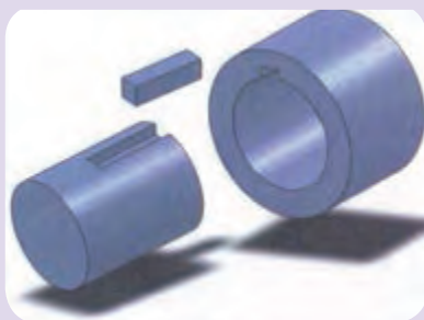
نمونه شیارهای راست گوشه
