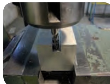
شیار تراشی با تیغه فرز انگشتی
