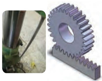
کاربرد چرخ و شانه در ماشین‌های مته
