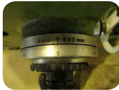
صفر کردن ورنیه دستگاه
