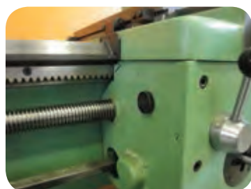
کاربرد چرخ و شانه در ماشین‌های تراش
