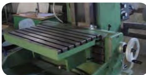
میز ماشین فرز و سیستم حرکتی آن
