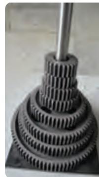
چرخ‌دنده‌های تعویضی برای ایجاد حالت مرکب یا ساده
