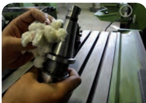
تمیز کردن دنباله میله فرزگیر
