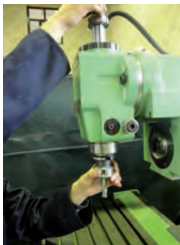
نحوه بستن کُلت بر روی دستگاه
