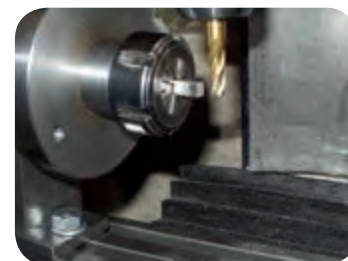
چهارگوش کردن قطعه به کمک دستگاه تقسیم
