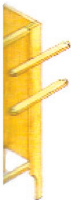
شکل ۶۳- ۸ موقعیت قیدهای عرضی داخلی در کابینت پایه‌دار
