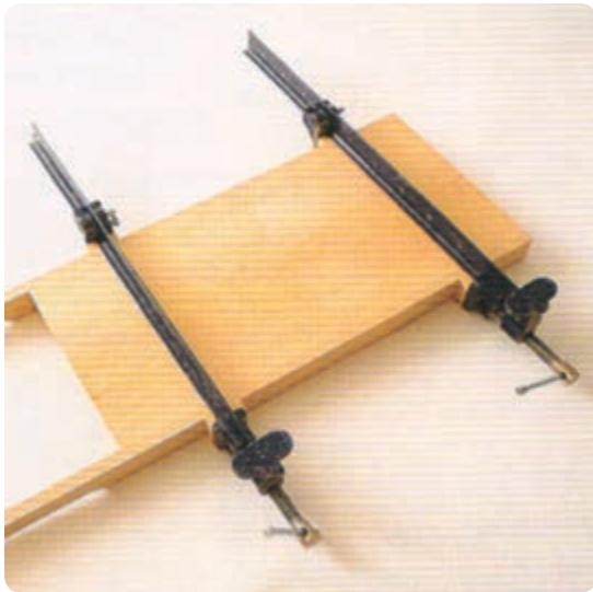
شکل ۵۹-۸ مونتاژ بدنه به پایه
