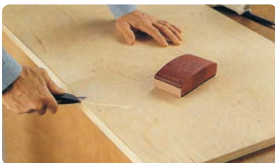
شکل ۷۷-۸ پرداخت لبه های اضافی روکش لبه چسبان
