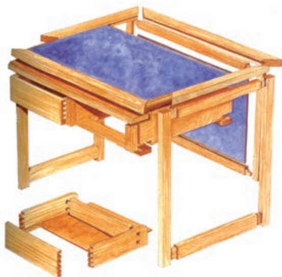
شکل ۶-۱۴۷ تصویر مجسم انفجاری مونتاژ
