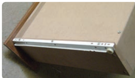
شکل ۶-۱۱۲ نصب ریل مکانیکی در زیر بدنه جعبه
