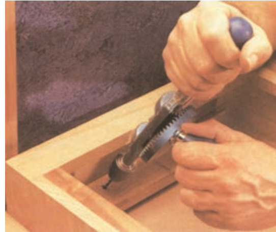
شکل ۱۶۱-۶ مونتاژ صفحه میز به قاب دراور
