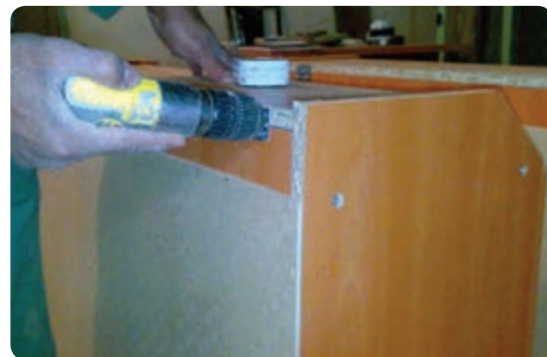
شکل ۱۳۱-۶ نصب لولای محفظه جاواکسی
