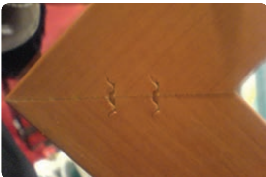
شکل ۹۴-۶ اتصال دوخت قاب
