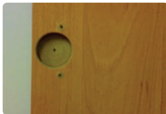
شکل ۶-۷۲ سوراخ کاری محل لولا و سوراخ محل پیچ لولا با دستگاه لولازن
