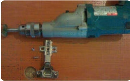
شکل ۱۲۸-۶ نصب لولای کابینت فنردار روی در کابینت
