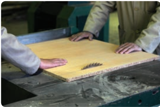
شکل ۶-۷۷ - برش در ساده کابینت
