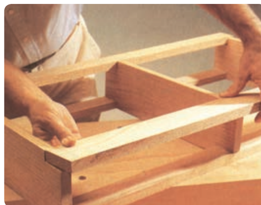
شکل ۶-۱۵۵ مونتاژ کلاف قاب دراور
