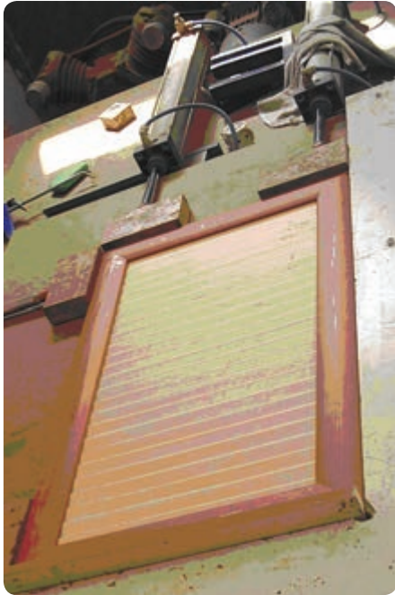
شکل ۶-۹۷ تنگ نیوماتیکی جهت مونتاژ در قابدار کابینت
