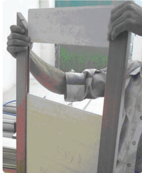
شکل ۶-۹۵ مونتاژ در قابدار با تنگه لته‌ای
