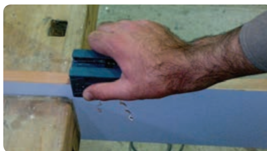
شکل ۶-۸۲ پرداخت لبه اضافی روکش
