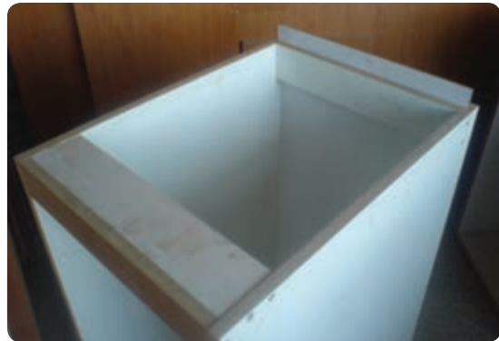
شکل ۶-۷۵ - مونتاژ کابینت با قرارگیری پشت‌بند
