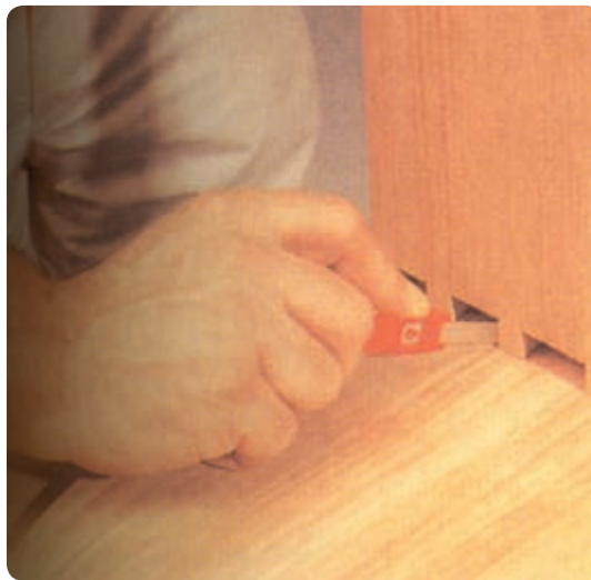
شکل ۶-۱۳۸ خط‌کشی جای فاق روی قطعه دیگر
