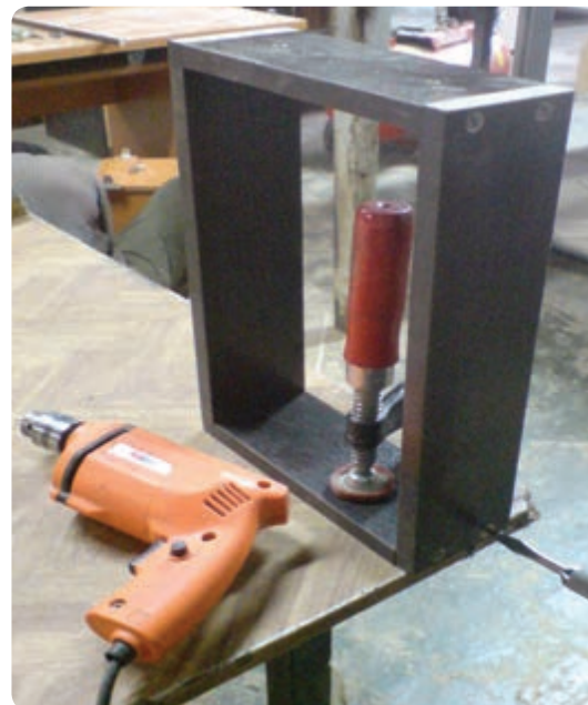
شکل ۶-۱۰۸ مونتاژ دستی جعبه کشو
