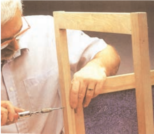
شکل ۶-۱۶۰ مونتاژ قاب پشت با قاب کناری
