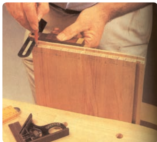
شکل ۶-۱۳۶ خط‌کشی اتصال دم‌چلچله دورو مخفی
