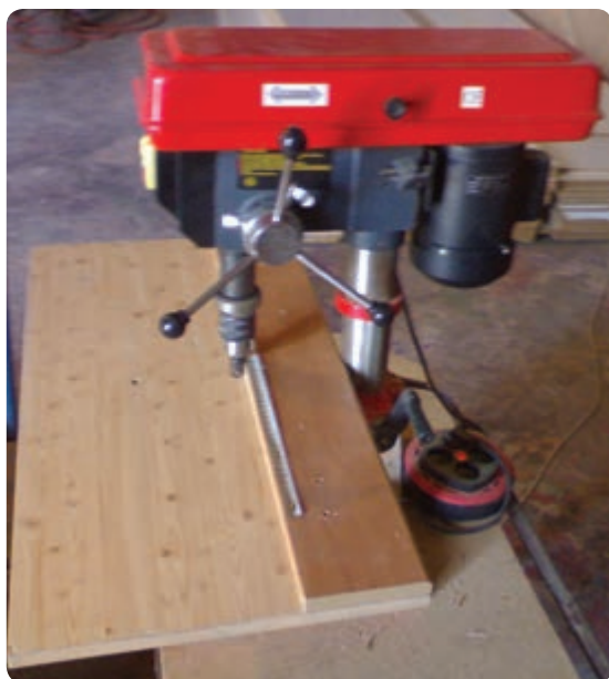
شکل ۶-۷۰- دریل ستونی همراه با شابلون جهت سوراخ‌کاری
