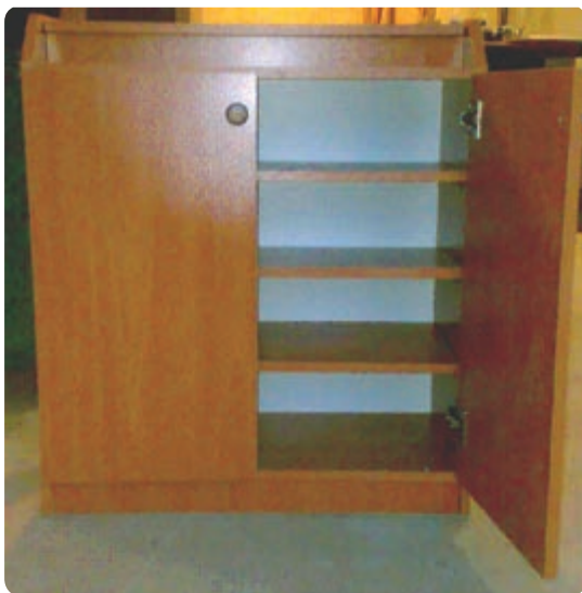
شکل ۱۳۲-۶ نصب يراق آلات در کابینت جاکفشی
