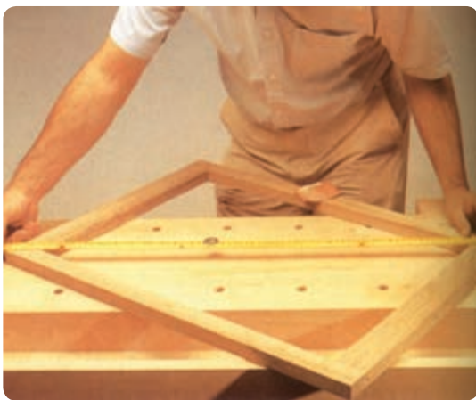
شکل ۱۵۰-۶ اطمینان از گونیایی قاب
