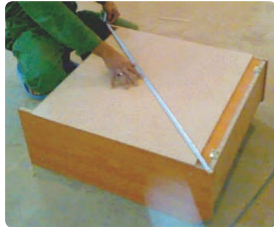
شکل ۱۳۰-۶ کنترل دويدگی کابینت
