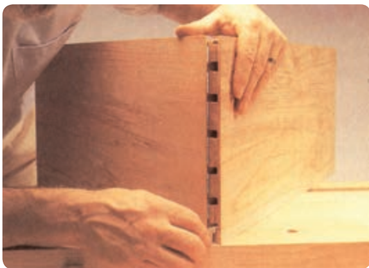
شکل ۶-۱۴۰ مونتاژ آزمایشی قبل از چسب زدن قطعات
