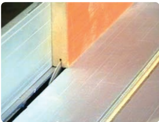
شکل ۶-۹۰ دو راهه کردن با ماشین اره مجموعه‌ای
