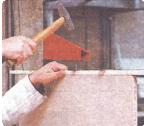
شکل ۷۸-۶ نصب زهوار چوبی لبه چسبان
