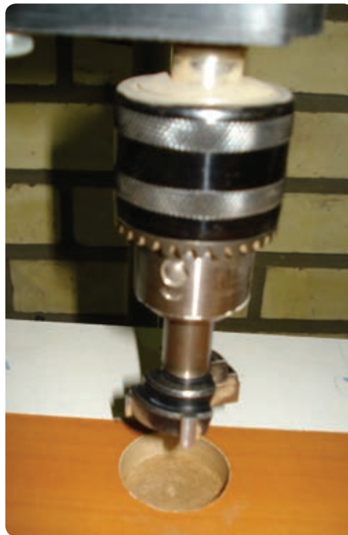
شکل ۶-۷۱ مته کابینت جهت سوراخ کردن جای لولا
