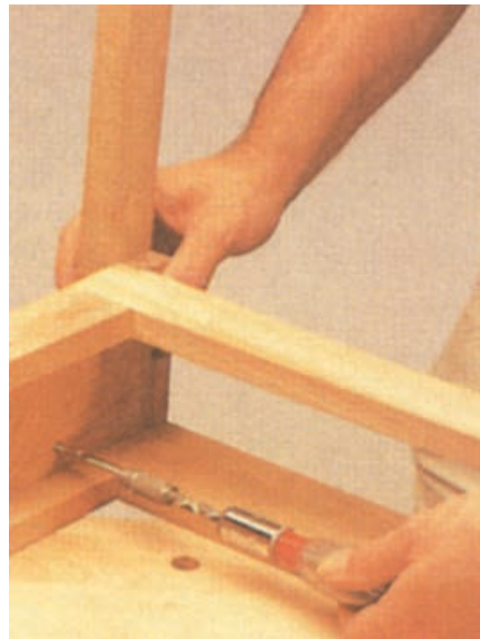
شکل ۶-۱۵۹ اتصال قاب دراور به قاب کناری
