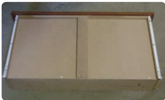
شکل ۶-۱۱۳ نصب قید کمرکش در کسوه‌های بزرگ
