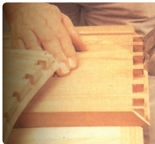
شکل ۶-۱۳۹ پرداخت لبه دو راهه شده بدنه کابینت با رنده بغل دو راهه
