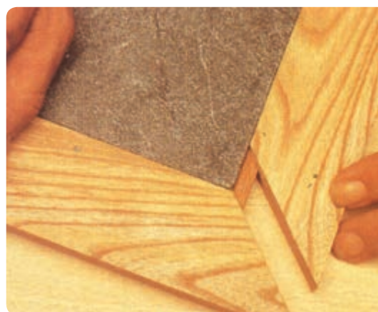
شکل ۶-۱۵۲ مونتاژ صفحه میز
