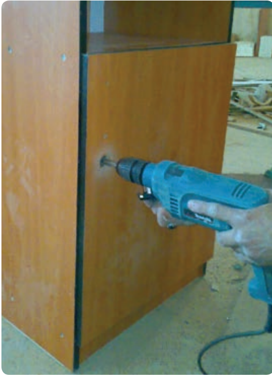
شکل ۱۲۳-۶ در آوردن جای قفل سوئیچی
