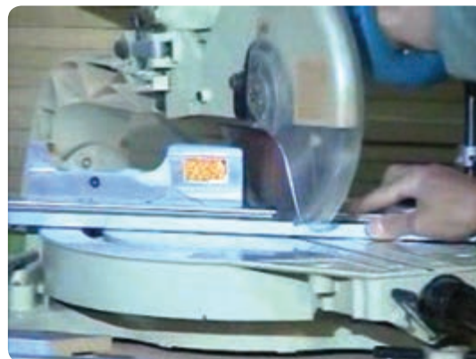
شکل ۹۲-۶ برش پروفیل‌ها با دستگاه فارسی بر
