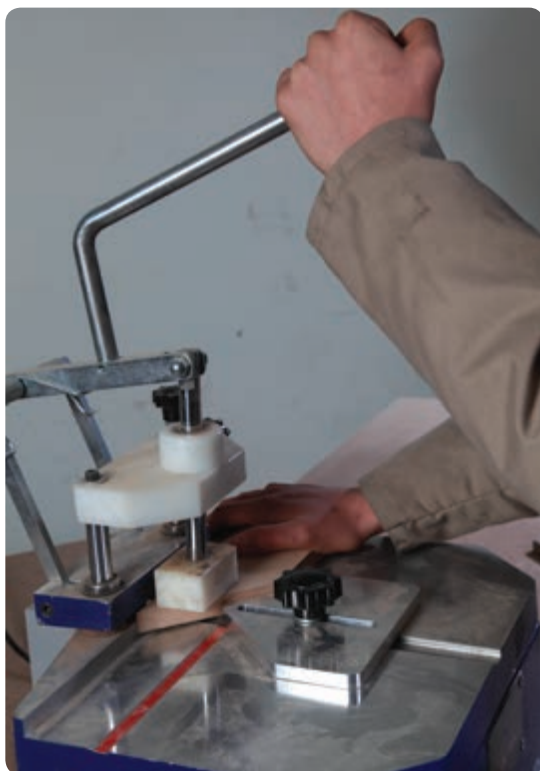
شکل ۹۳-۶ اتصال دم چلچله زن پروفیل
