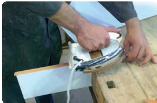
شکل ۶-۸۱ لبه چسبانی روکش مصنوعی با اتو
