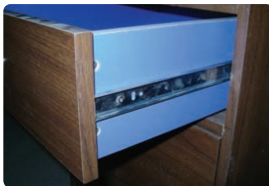
شکل ۵۶-۶ ریل مکانیکی نصب شده در بدنه جعبه
