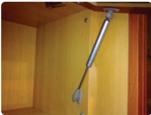
شکل ۶-۳۶ در کابینت با درجه یا نگه‌دارنده پمپی
