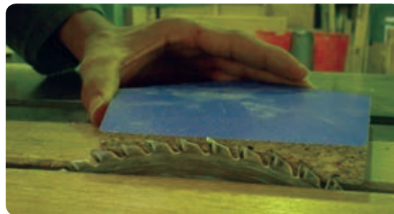
شکل ۳-۳۸ تنظیم ارتفاع تیغه اره
