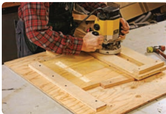
شکل ۳-۲۹ شابلون تسریع کننده و حفاظتی اورفرز
