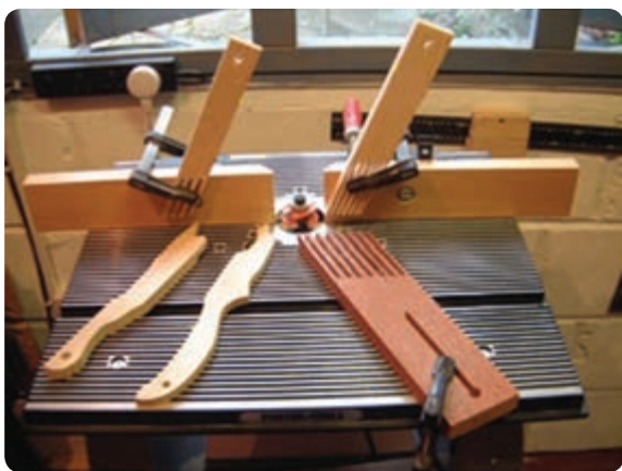
شکل ۳-۲۸ شانه‌های حفاظتی به صورت عمودی
