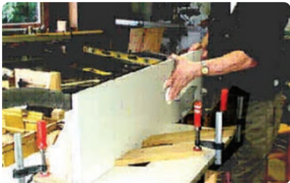
شکل ۳-۲۷ شانه‌های حفاظتی به صورت افقی
