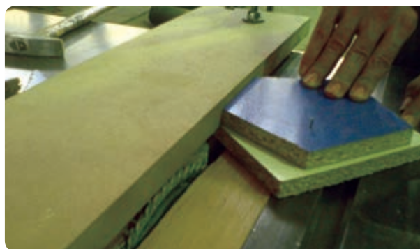
شکل ۳-۴۰ مماس کردن به گونیا و انجام دادن برش
