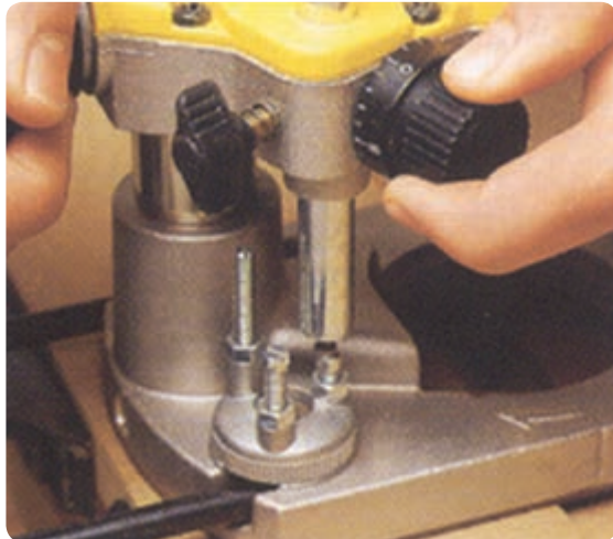
شکل ۲-۷۲ پیچ‌های تنظیم دستگاه
