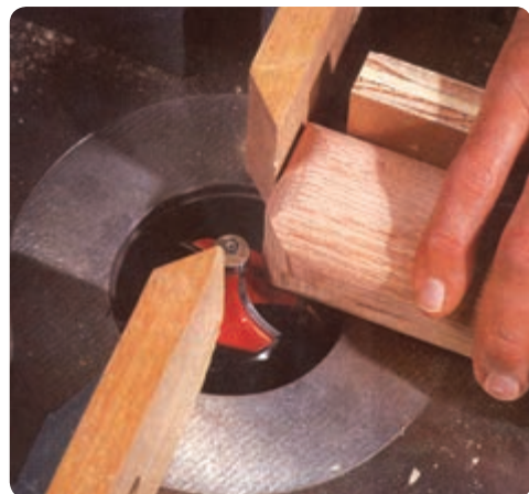
شکل ۶۳-۲ فرز زدن کله چوب با اورفرز دستی برقی
