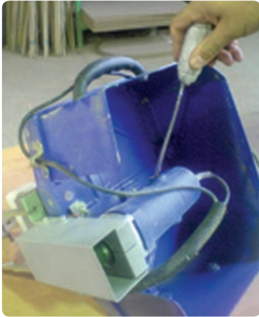
شکل ۱۱۷-۲ تصویر از زیر دستگاه گرفته شده است که درپوش بیجی زغال کلکتور جهت بازدید باز می‌شود
