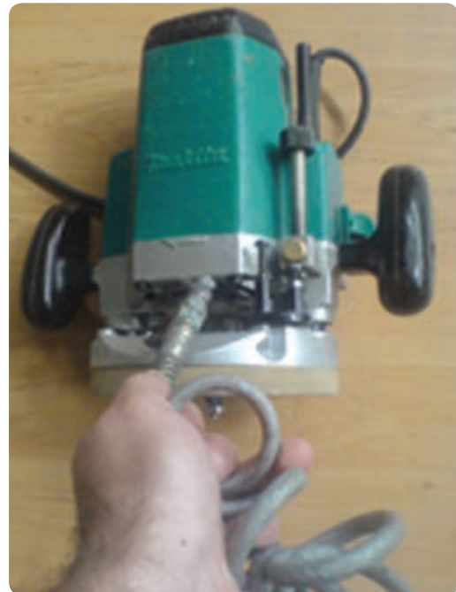
شکل ۲-۷۱ بادگیری دستگاه پس از پایان کار
