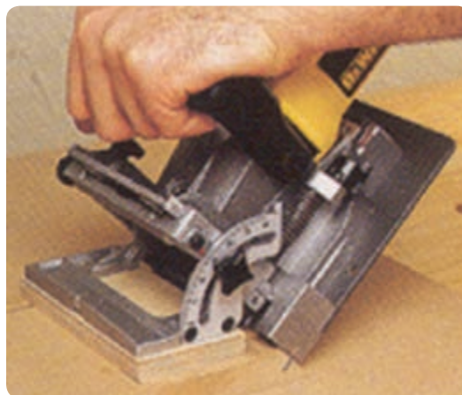
شکل ۲-۹۰ شیارزنی با زاویه ۴۵ درجه
