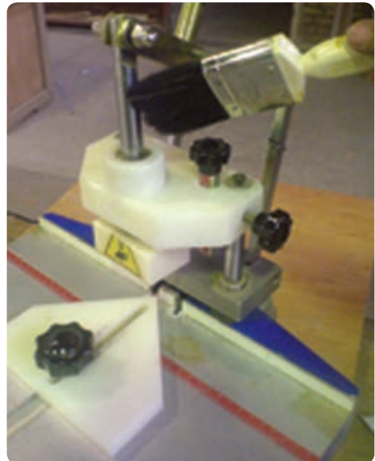
شکل ۱۱۶-۲ تمیز کردن مفصل‌های حرکتی ماشین دم چلچله‌زن
