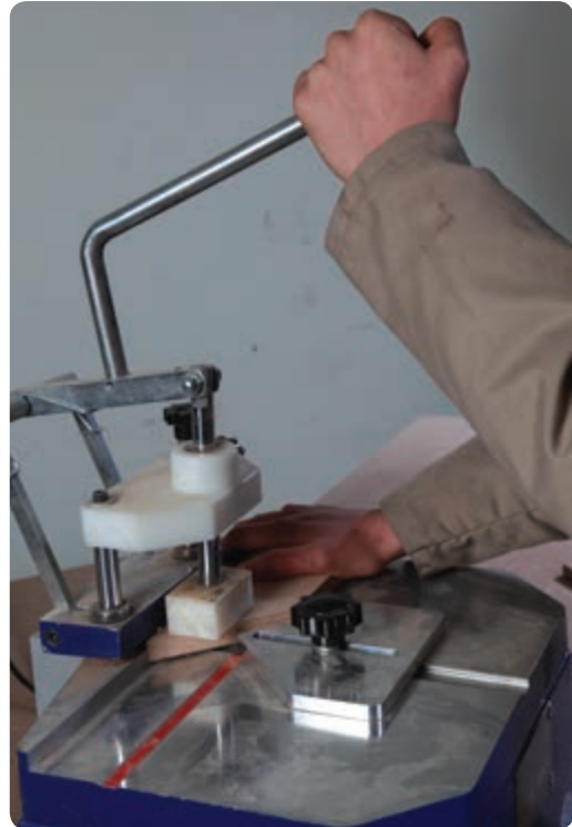
شکل ۲-۱۱۲ برش با زاویه ۴۵ درجه
