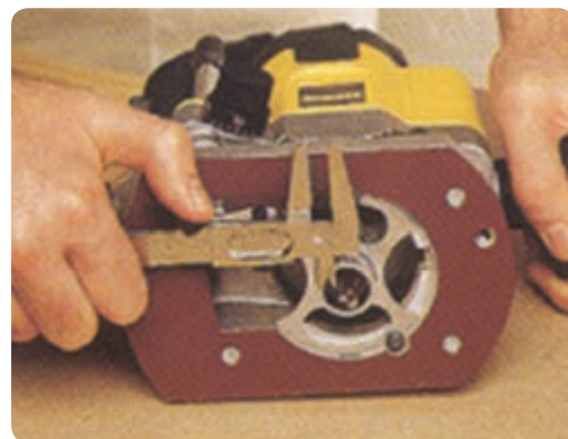
شکل ۲-۶۸ اندازه‌گیری قطر شفت فرز
