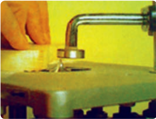
شکل ۶۵-۲ بلبرینگ هدایت برای قطعات قوس‌دار
