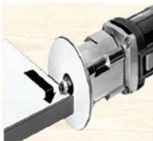
شکل ۱۵۵-۲ پرداخت لبه های اضافی روکش مصنوعی
