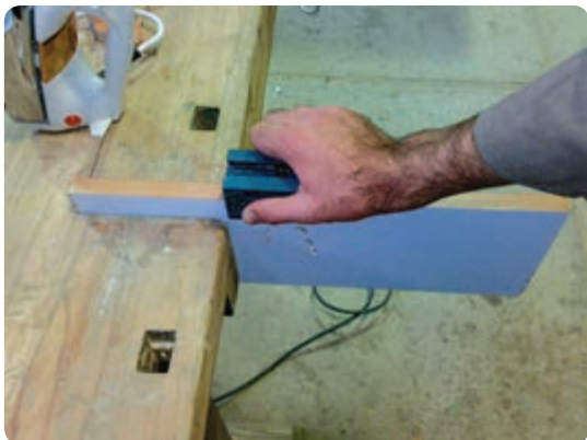
شکل ۱۵۶-۲ رنده پرداخت لبه نوار روکش لبه چسبان
