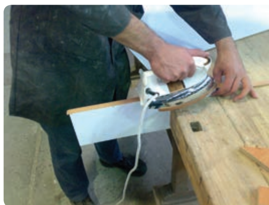
شکل ۱۴۷- اتوکشی نوار روکش لبه‌چسبان
