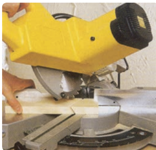
شکل ۱۴-۲- برش تحت زاویه
