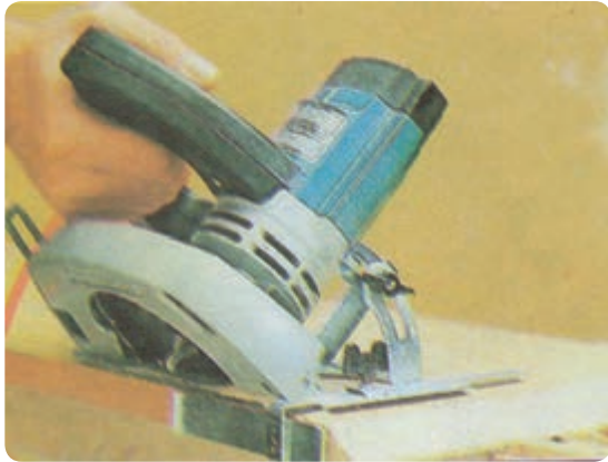
شکل ۲-۳۷ برش تحت زاویه به وسیله گونیای دستگاه
