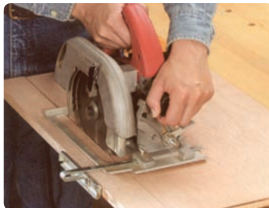
شکل ۲۲- برش عرضی با گونیای ماشین
