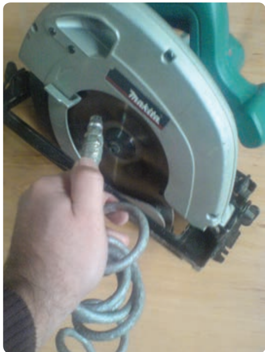
شکل ۲۵- تمیز کردن دستگاه با هوای فشرده پمپ باد
