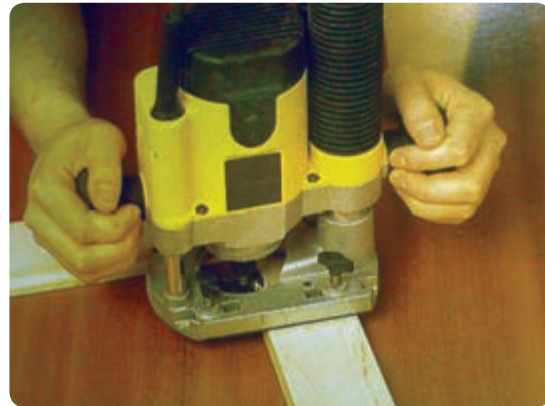
شکل ۵۹-۲ فرزکاری داخل قاب
