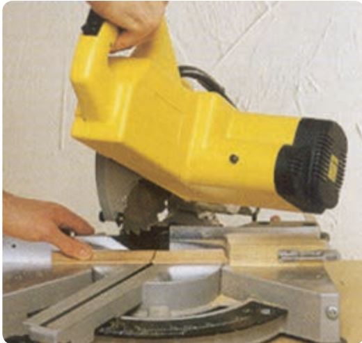
شکل ۲-۱۲- برش قائم با اره گرد فارسی بر
