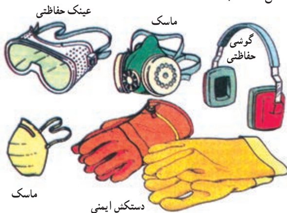
شکل ۲-۳۸ استفاده از وسایل حفاظتی
