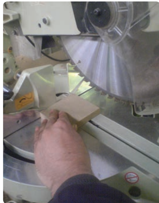
شکل ۲-۱۶ - عدم رعایت نکات ایمنی برای برش قطعات کوچک‌تر
