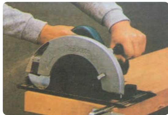
شکل ۲-۳۶ برش به وسیله گونیای دستگاه
