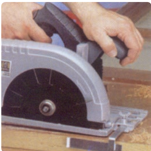
شکل ۲۰-۲ بکارگیری اره گرد دستی برقی
