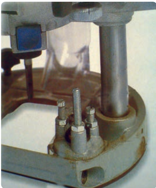
شکل ۲-۴۴ پیچ‌های تنظیم ارتفاع اور فرز دستی برقی
