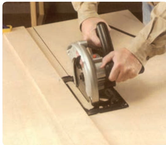
شکل ۲۳- برش طولی با گونیای برراستی
