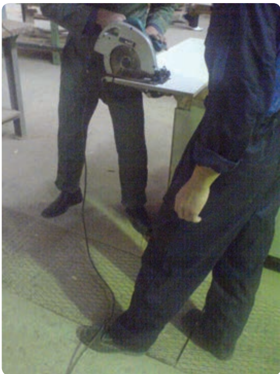
شکل ۲۷-۲ سیم سیار در مسیر نباشد
