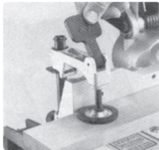
شکل ۲-۱۱- بستن قطعه کار با گیره
