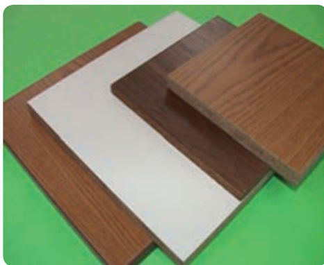
شکل ۱-۲۵ تخته خرده‌چوب روکش شده با پی‌وی‌سی
