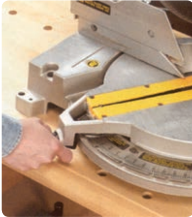
شکل ۲-۸ تنظیم زوایای مختلف برش
