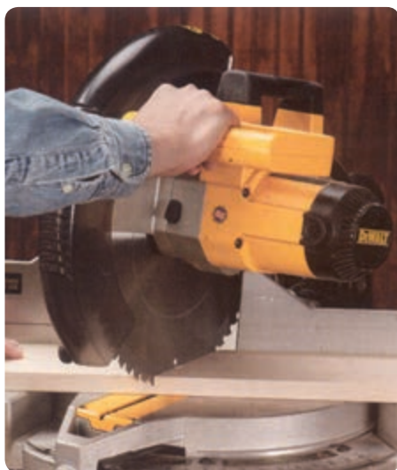
شکل ۲-۵ حرکت اهرمی در اره گرد فارسی بر
