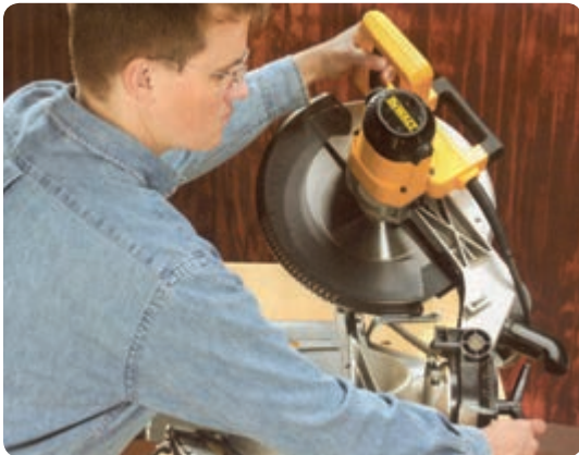
شکل ۲-۹ تنظیم زاویه چرخش اره گرد
