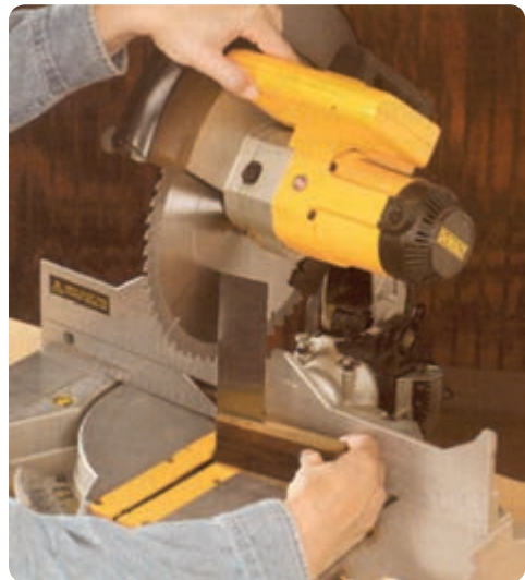
شکل ۲-۷ تنظیم عمود بودن تیغه پشت به صفحه
