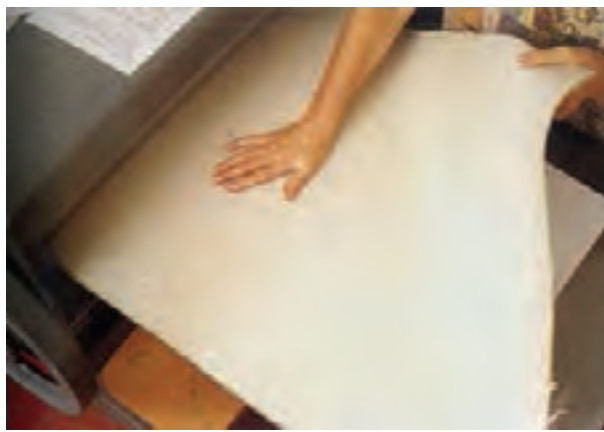
تصویر ۱۸۴- قرار دادن نمدر روی کلیشه و مقوا
