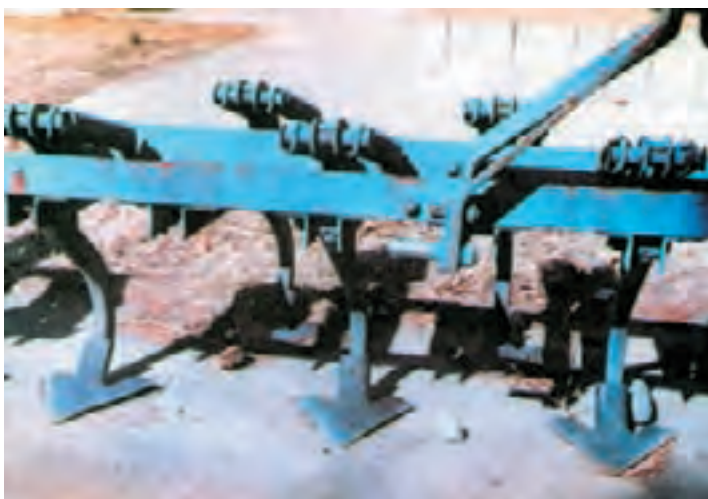
ج- پنجه شاخه‌ای با تیغه‌ی پنجه‌غازی برای سله شکنی اراضی دیم در فواصل قطع بارندگی
