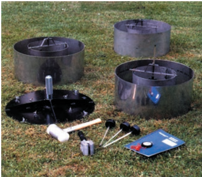
شکل ۱۰-۳ استوانه مضاعف وسیله اندازه‌گیری نفوذپذیری
