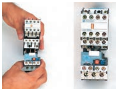
شکل ۵-۴۰- نحوه قرارگیری بی‌متال زیر کنتاکتور
