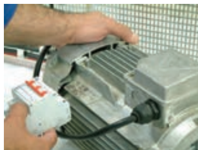
شکل ۸۱-۵- دقت به پلاک موتور هنگام انتخاب فیوز
