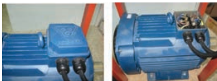
شکل ۵-۱- پلاک اتصالات موتور الکتریکی سه فاز
