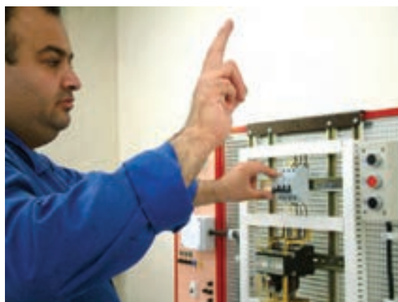
شکل ۶۸-۵- وصل همزمان سه فیوز در مدارات راه‌اندازی موتورهای سه فاز
