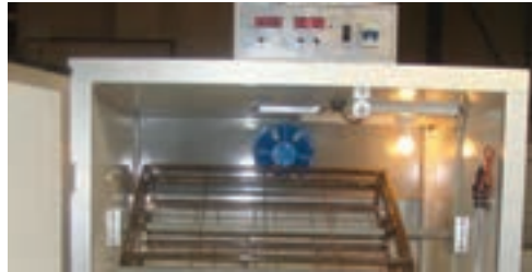
الف) هواکش دستگاه جوجه‌کشی
