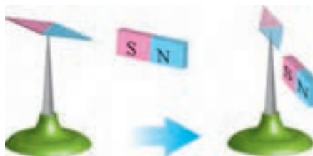
شکل ۲۲-۴- ورق آهنی حرکت آهنربا را دنبال می‌کند.
