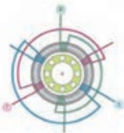
شکل ۲۳-۴- سیم پیچ‌های موتور الکتریکی
