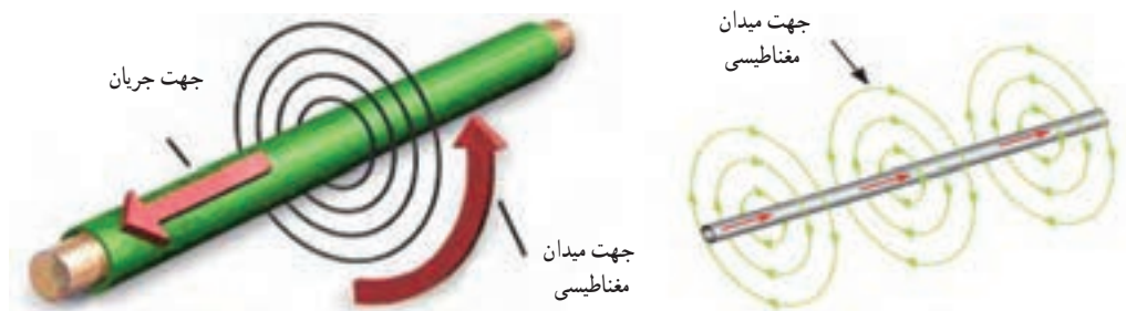
شکل ۴-۴- خاصیت مغناطیسی اطراف سیم حامل جریان
