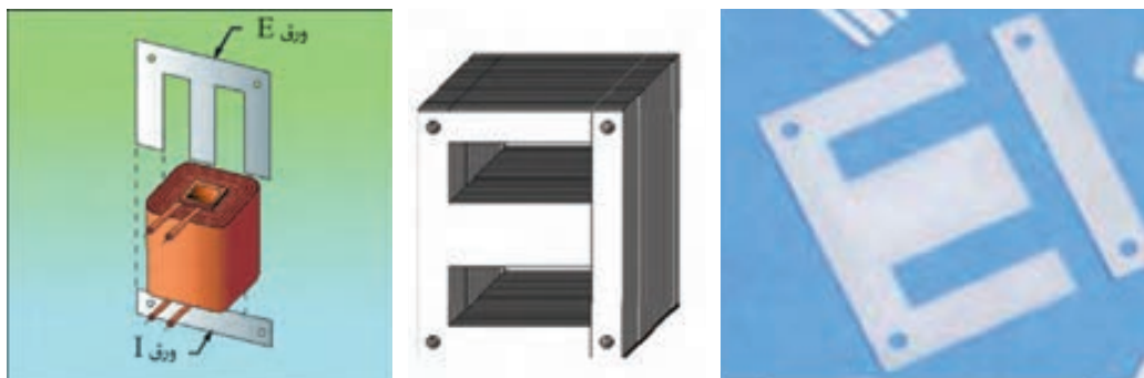
شکل ۹-۴- هسته آهنی ترانسفورماتور
