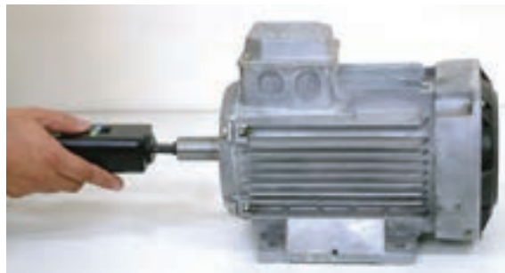
شکل ۲۷-۴- نحوه اندازه گیری سرعت دورانی موتور
