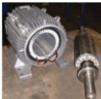
شکل ۱۷-۴- استاتور و روتور موتور آسنکرون
