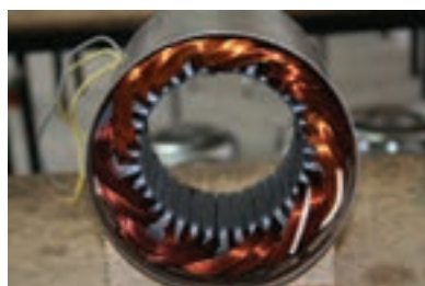
شکل ۱۴-۴ سیم پیچ‌های یک موتور الکتریکی
